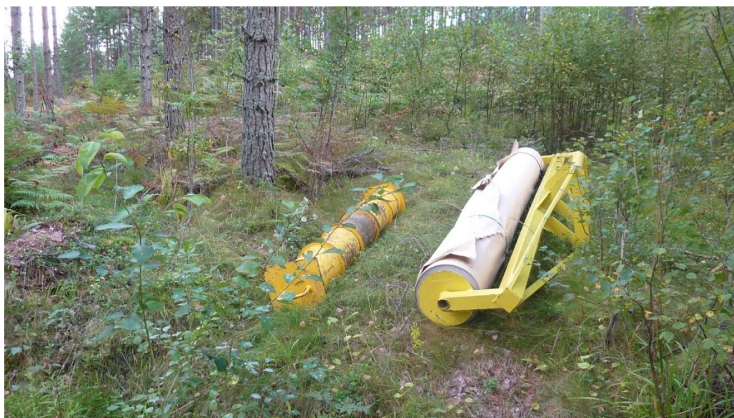
Figur 18. Till höger i bild ses en rulle med täckpapp fäst i en s.k. galge. Skotaren kan med sin kran rulla ut täckpappen genom att lyfta galgen och rullen över vältan. Pappen förankras därefter med ett lager ris ovanpå för att inte blåsa sönder (Figur 19). Pappen ger ett mycket bra skydd mot fukt och kan senare sönderdelas och förbrännas tillsammans med flisen. Foto: Tomas Johannesson.
