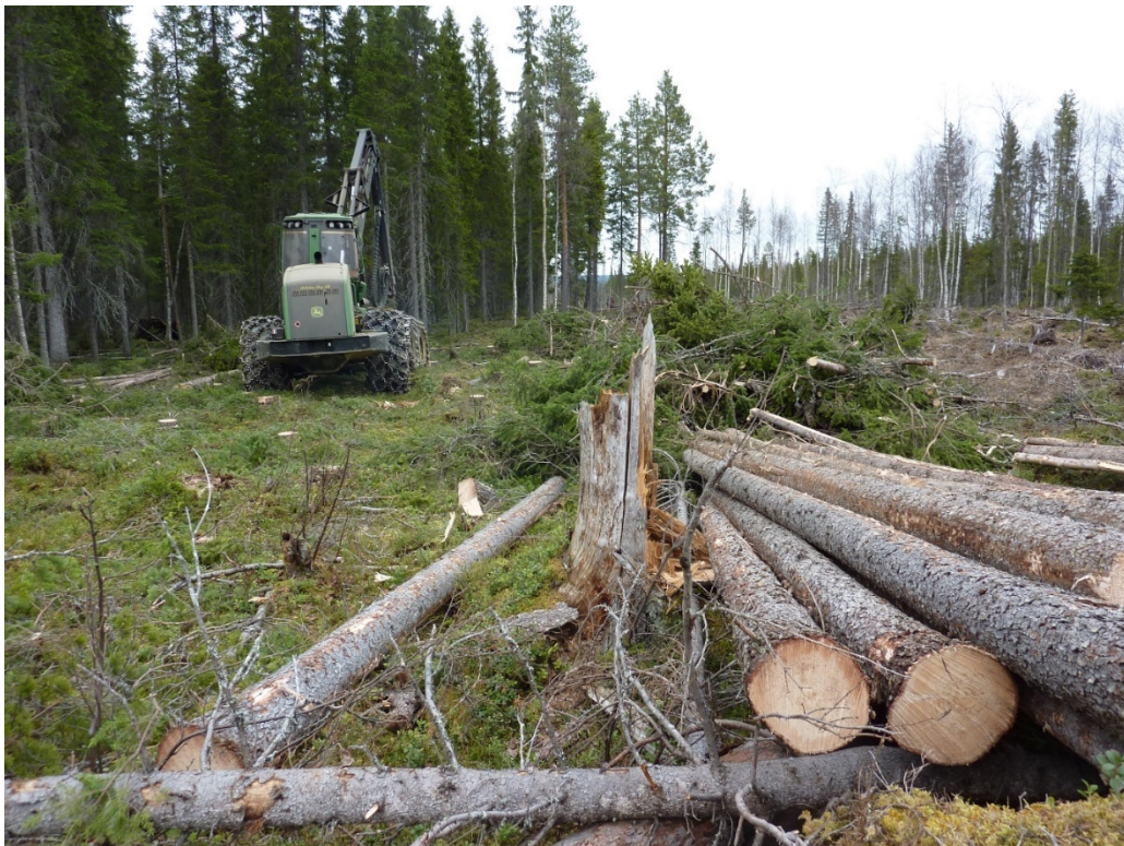
Figur 17. Grotanpassad avverkning där ris och virke placeras i högar längsefter maskinens körstråk. Foto: Tomas Johannesson
