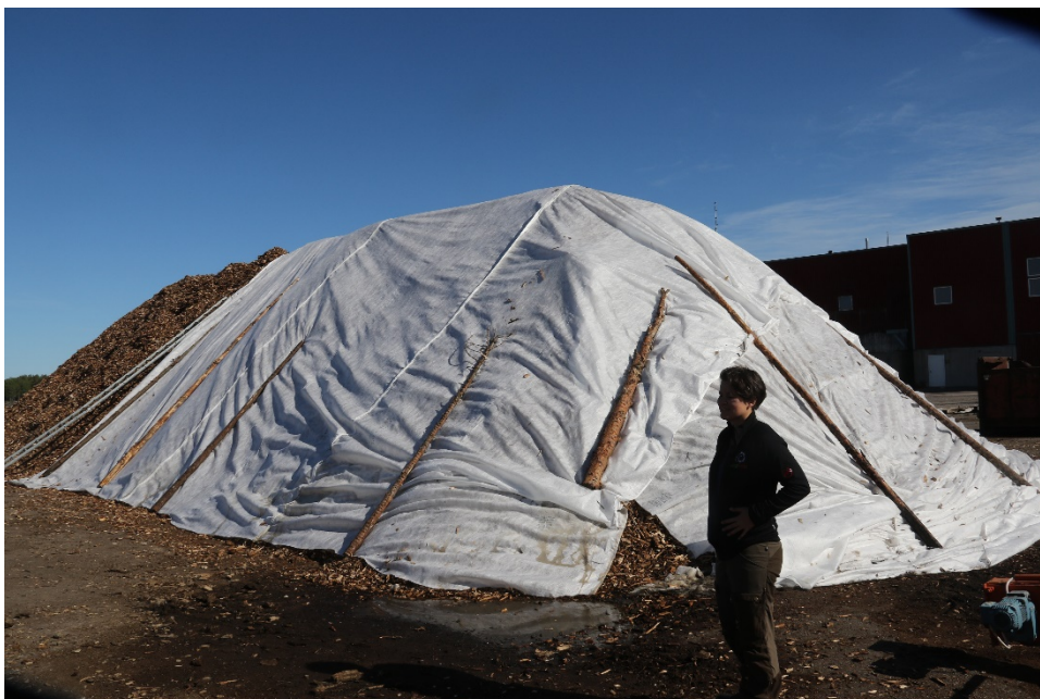
Figur 39. Flisstack som till hälften är täckt med TopTex i ett lagringsförsök som genomfördes i Norrsundet. Foto: Lars Eliasson.
