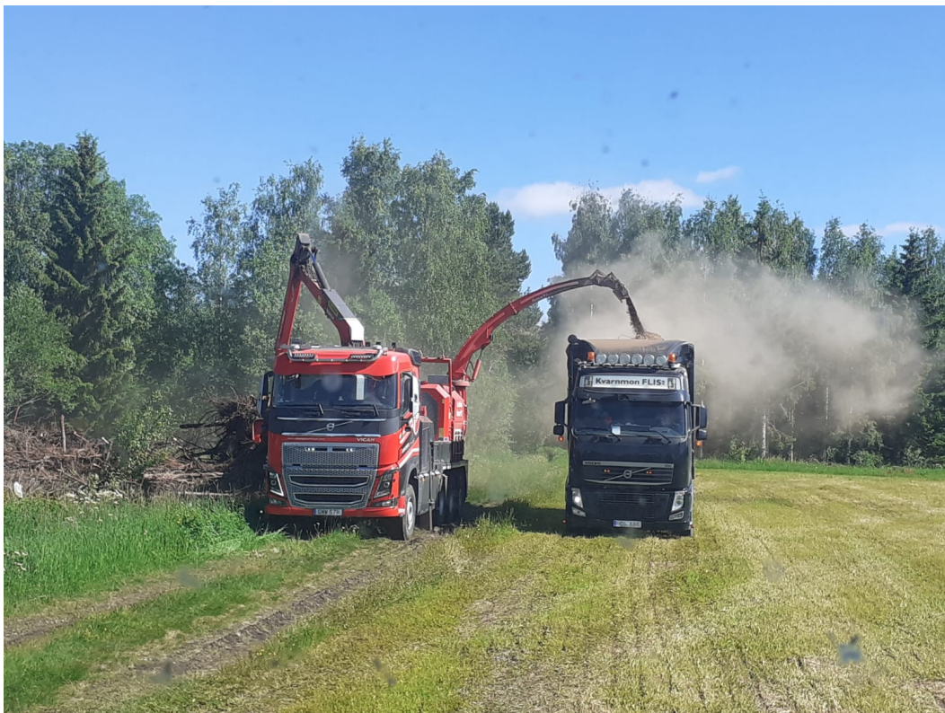
Figur 33. Lastbilsmonterad separathugg som flisar grot direkt i lastutrymmet på en flisbil. Foto: Kvarnmon Flis AB.
