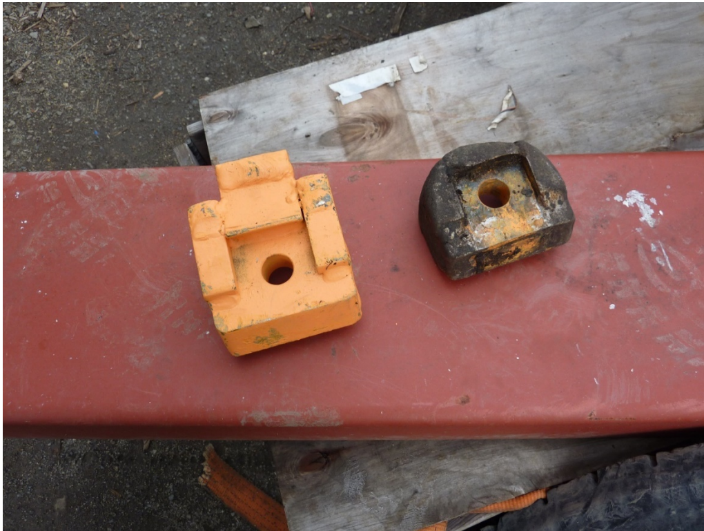
Figur 24. Bilden visar en ny kross-sлага till vänster och en utsliten kross-sлага till höger i bild. Kraftigt slitna slagor påverkar prestation och kvalitet på det krossade bränslet. Foto Tomas Johansson.
