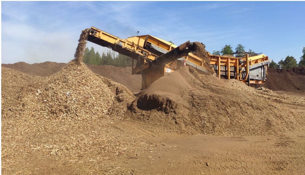
Figur 38. Stjärnsikt som delar upp grotflis i en rejektfraktion och en acceptfraktion. Foto: Anders Eriksson.
