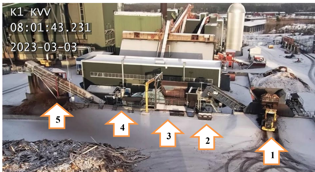
Figur 44. Bilden visar delar av bränslehanteringen på Jämtkrafts anläggning i Östersund. Vid pil 1 lastar en hjullastare returträ i en förkross. Materialet passerar därefter en magnetisk metallavskiljare (pil 2) och vidare in i en slutkross (pil 3). Efter slutkrossning passerar ännu en magnetisk metallavskiljare (pil 4) och det färdigbearbetade bränslet går vidare in mot pannan (pil 5). Foto: Jämtkraft.
