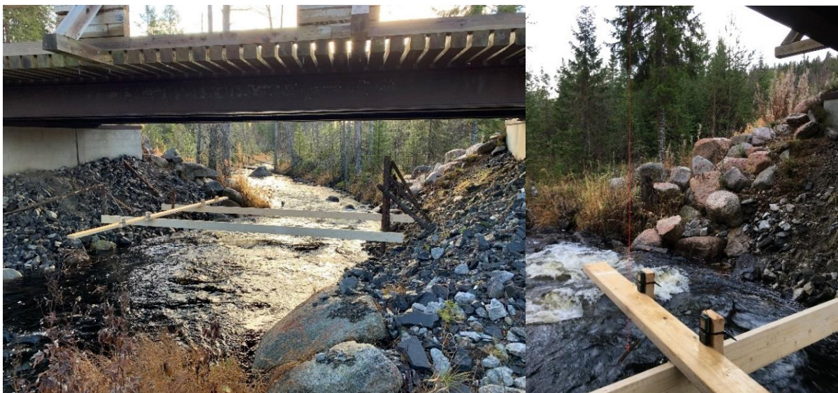
Figur 9. Vänster: Rigg för mätverktyg. Höger: Två av fyra lasermätare.
