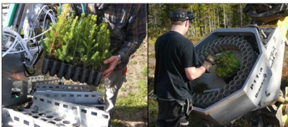
Figur 5. Plantkarusellen till Bracke P11. Till vänster MagMat-karusellen där hela Hiko-kassetter laddas och till höger den ordinarie karusellen där plantorna laddas styckvis. Från Ersson (2014).
