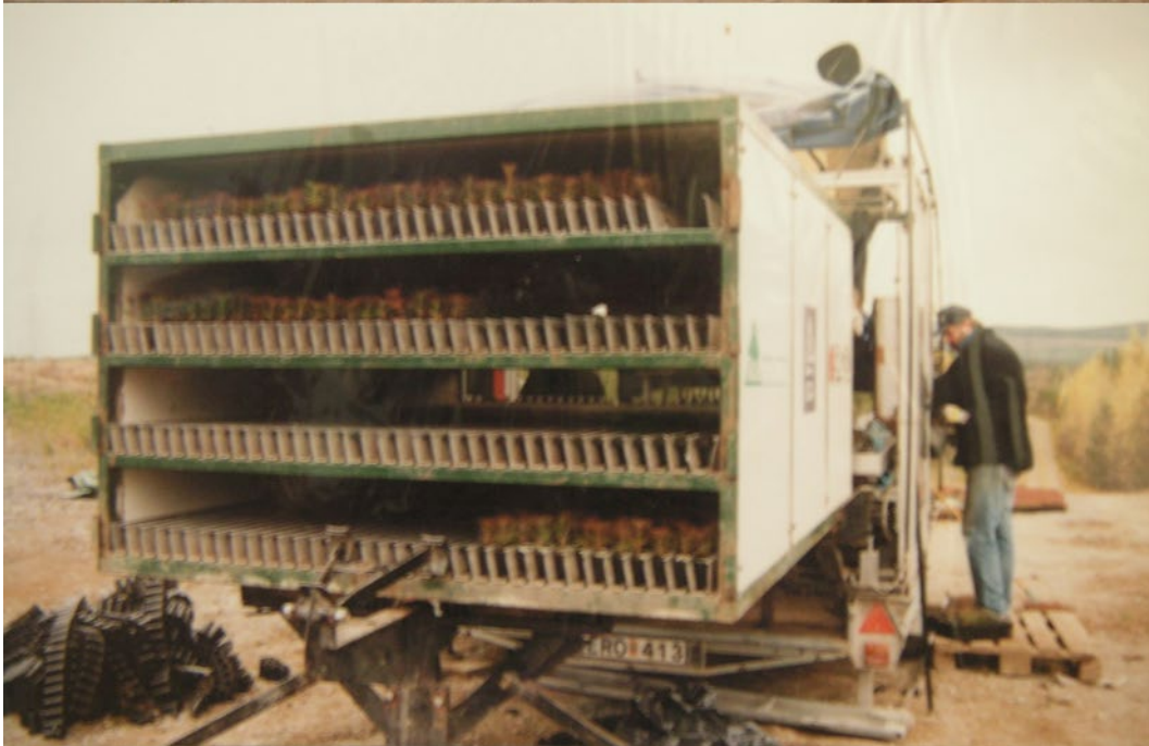
Figur 4. Överföring av plantor från odlingskrukor till PLS-krukpatronband vid avlägg via en släpvagnsburen plockrobot för plantering med SCA:s Silva Nova år 1998. Överst: ettåriga tallplantor i odlingskassetter matades längs ett rullband in i plockroboten. Nederst: PLS-krukorna lastades automatiskt in i en container som rymde ca 100 bälten á 70 plantor per bälte (Ersson 2010). Containern lyftes sedan upp på Silva Novan med hjälp av basmaskinens (skotarens) kran. Ursprungliga foton: Mats-Åke Lantz, SCA.
