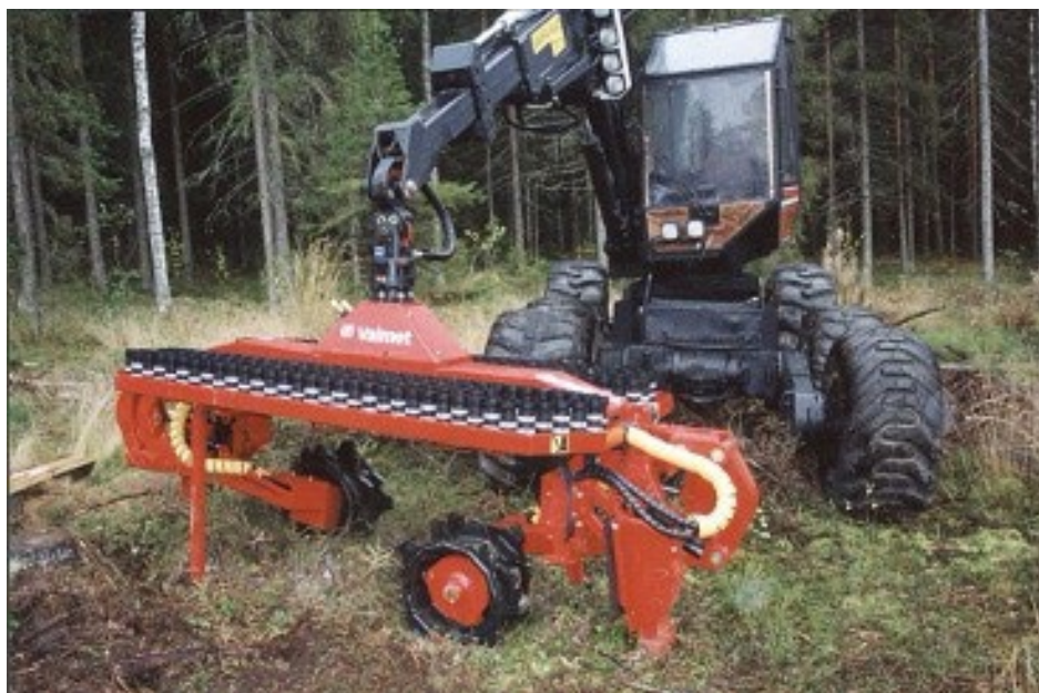
Figur 12. Det på skördare kranspetsmonterade planteringsaggregatet EcoPlanter. Foto: Henrik von Hofsten.
