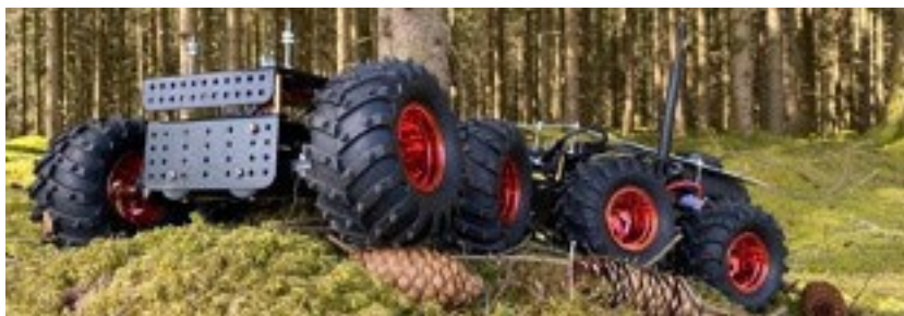
Figur 18. BraSatt-projekt: Minibeaver, testplattform för styrsystem. Foto: Karl Svensson.
