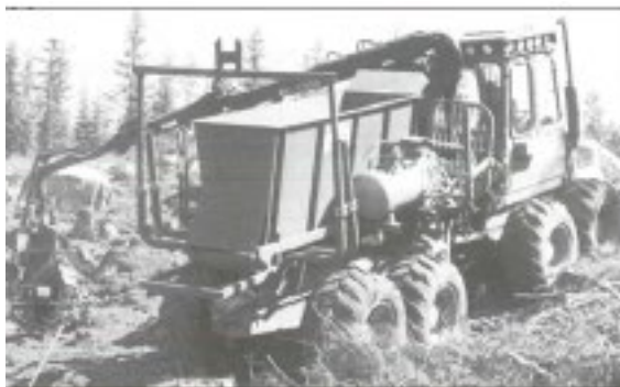
Figur 9. Planteringsmaskinen Doppingen som planterade ytligt med fylljord. Foto: Adelsköld & Myhrman (1985), hämtat från Ersson (2014).
