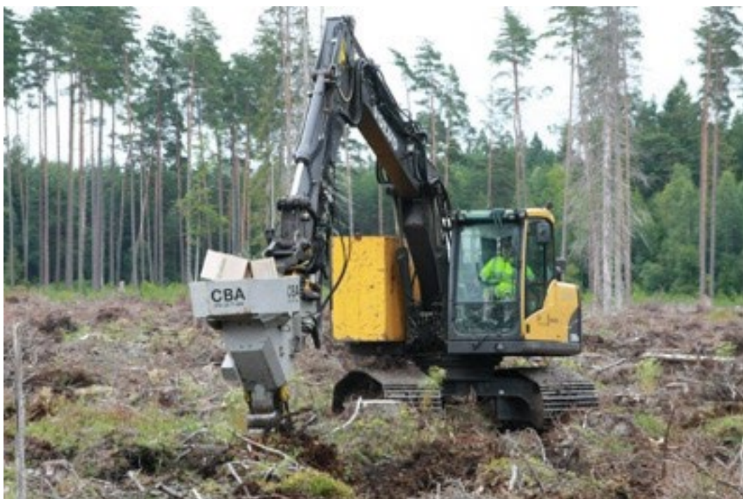
Figur 13. Det på grävare kranspetsmonterade planteringsaggregatet Bracke Planter P11 i trakten av Växjö. Foto: Mats Hannerz.
