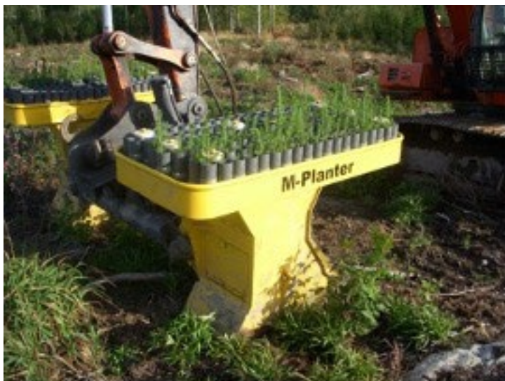
Figur 14. M-Planter, med två planteringshuvuden, monterad på en bom på en grävmaskins kran. Foto: Skogforsk.
