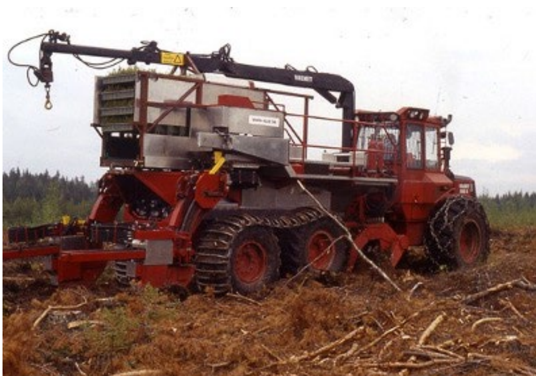
Figur 5. Serlachius Oy/Ab:s planteringsmaskin. Foto: Metsäteho.
