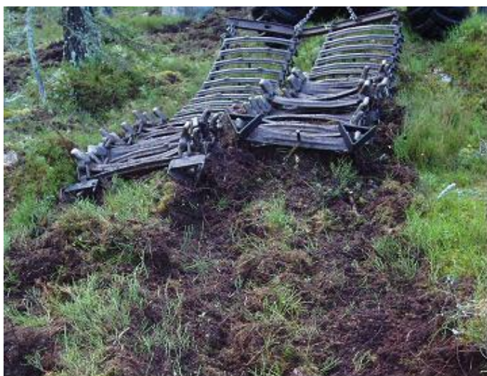
Figur 3. Markberedning med dubbelvikta skotrarband. Foto: Peter Wallin, Boxholms Skogar AB.
