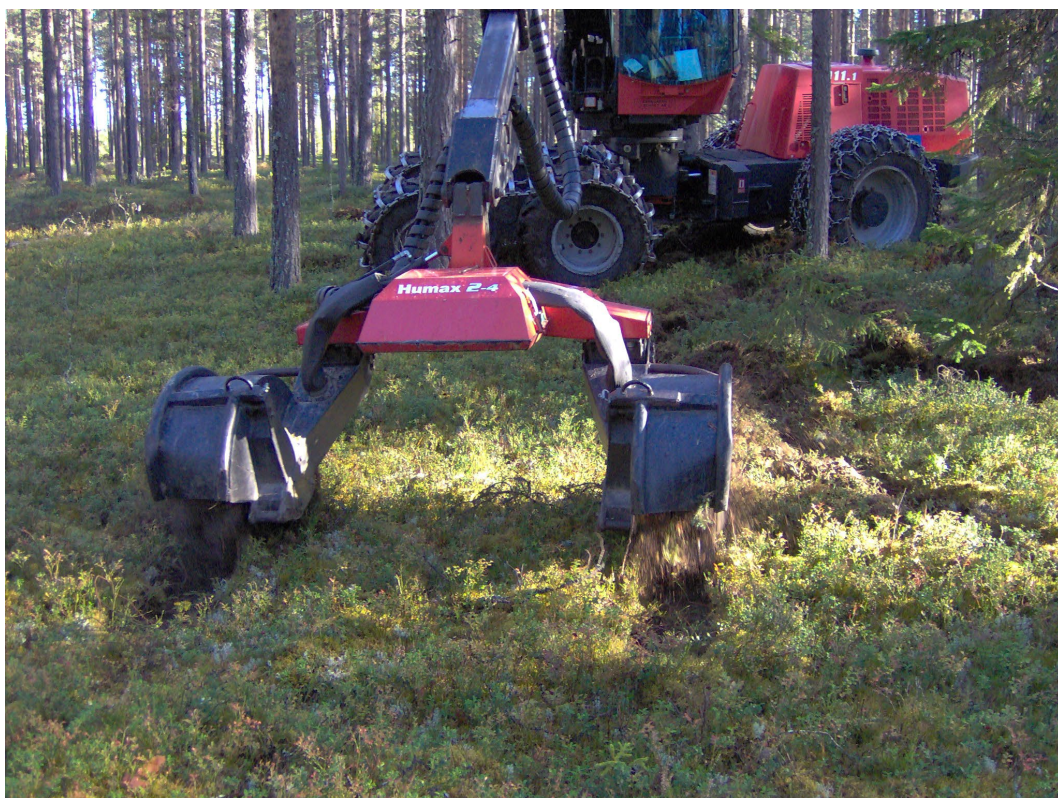
Figur 1. Markberedning med markberedningsaggregatet Humax 2-4.
