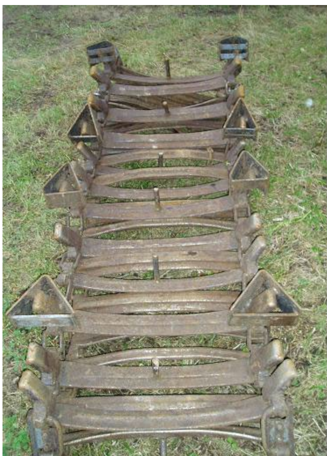
Figur 4. Dubbelvikta skotrarband som försetts med "järnplogar". Foto: Peter Wallin, Boxholms Skogar AB.
