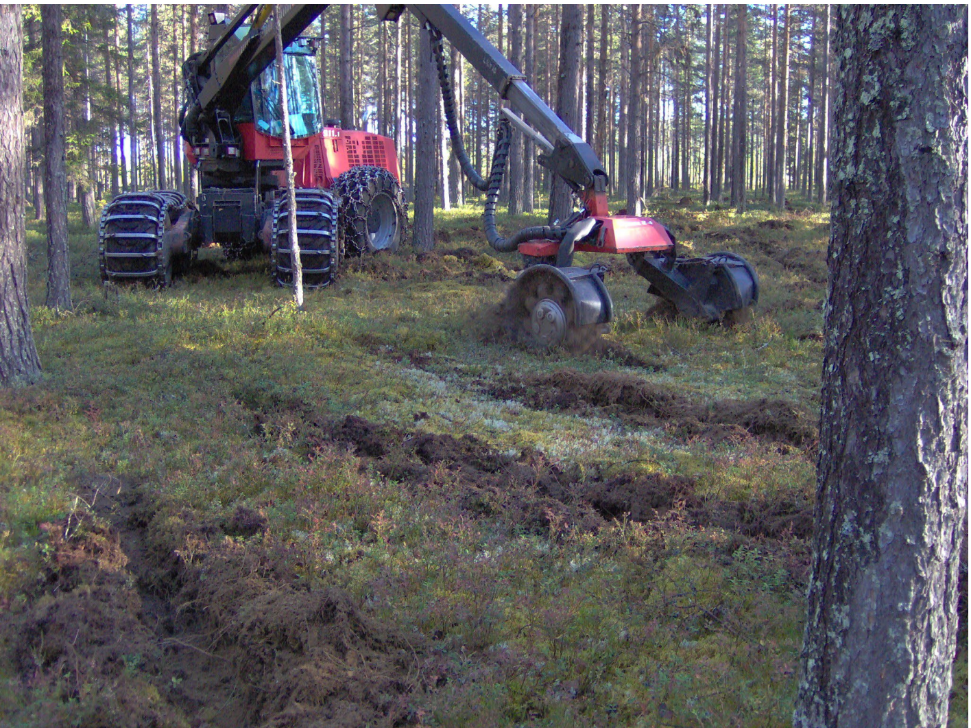
Markberedning i slutavverkningsbestånd med kranspetsmonterat aggregat Humax 2-4 (modifierat). Västerbotten år 2005. Foto. Birger Eriksson
