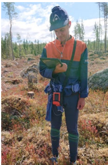
Figur 9. Manuell referensmätning av geometrier för lämnade och avverkade ytor med hjälp av handburen GNSS-mottagare.
