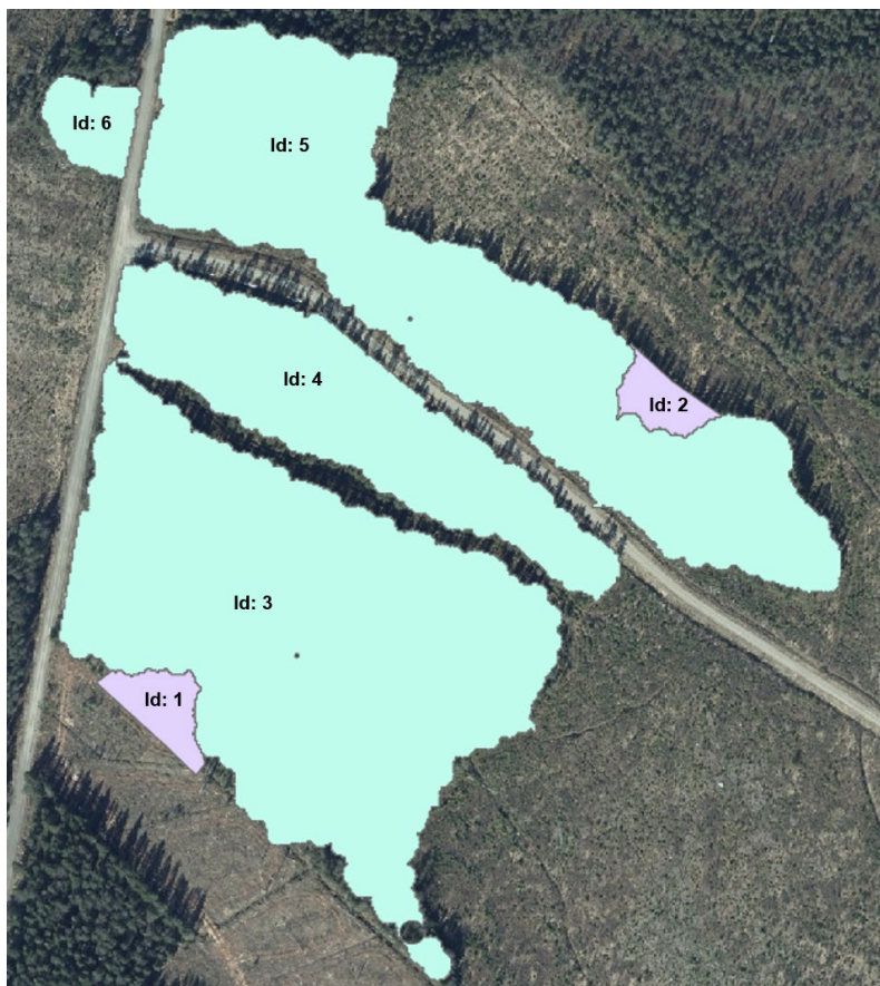
Figur 5. Exempel på geometrier genererade från arealberäkningsalgoritmen för ett objekt. I figuren indikeras avverkade ytor och större lämnade trädgrupper med grön respektive lila färg.
