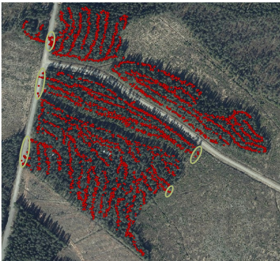
Figur 4. Karta över ett avverkningsobjekt där röda punkter symboliserar avverkningspositioner, det vill säga basmaskinens position vid upparbetning av stammarna. Avverkningspositioner belägna på väg eller intilliggande hygge (gröna ellipser) identifieras med hjälp av data från den nationella vägdatan respektive skogliga grunddata och exkluderas vid bestämningen av den avverkade ytans utbredning.
