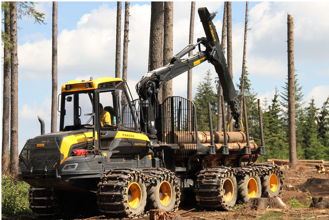
Figur 5. Skotaren Ponsse Buffalo 10W med extra långa band på bakvagnen. Foto: Ponsse Pics.
