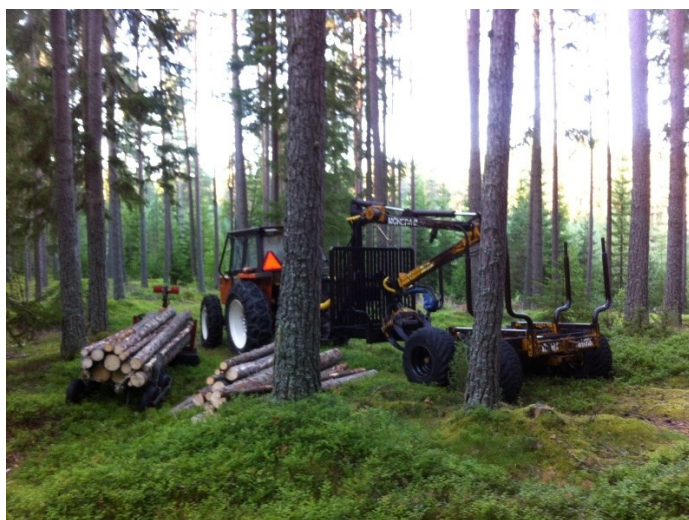
Figur 3. Exempel på småskalig teknik för att skonsamt hämta spridda skadade träd.
