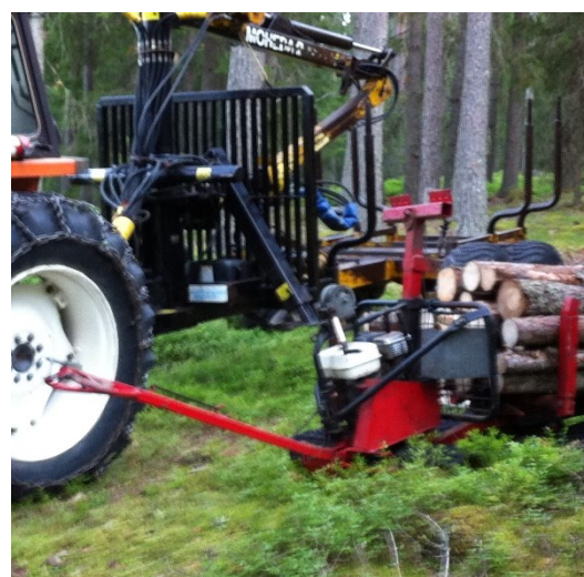
Figur 3. Exempel på småskalig teknik för att skonsamt hämta spridda skadade träd.
