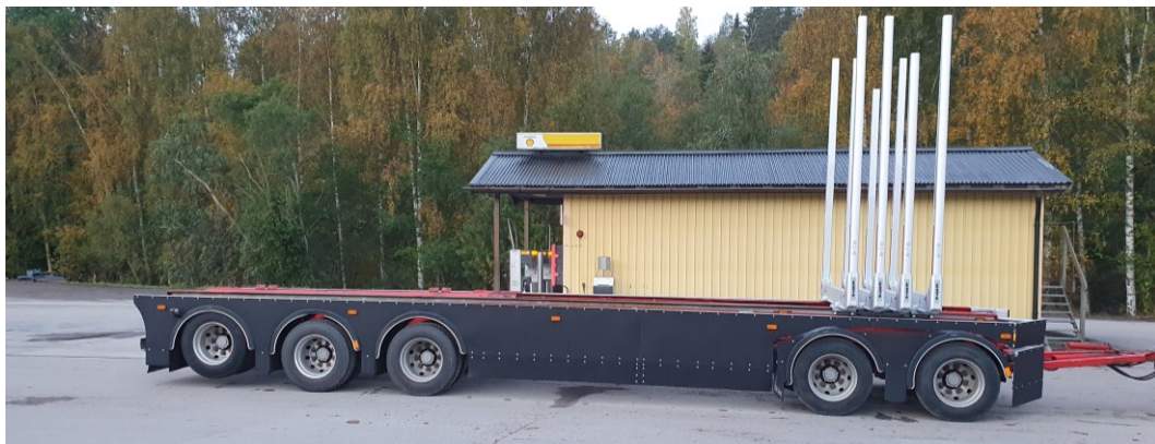
Figur 35. Den aero-kittade släpvagnen från Fröjds åkeri i Kisa. På bilden har stakar och bankar ställts ihop inför aerodynamiska studier för att efterlikna användande av Flexrow.
