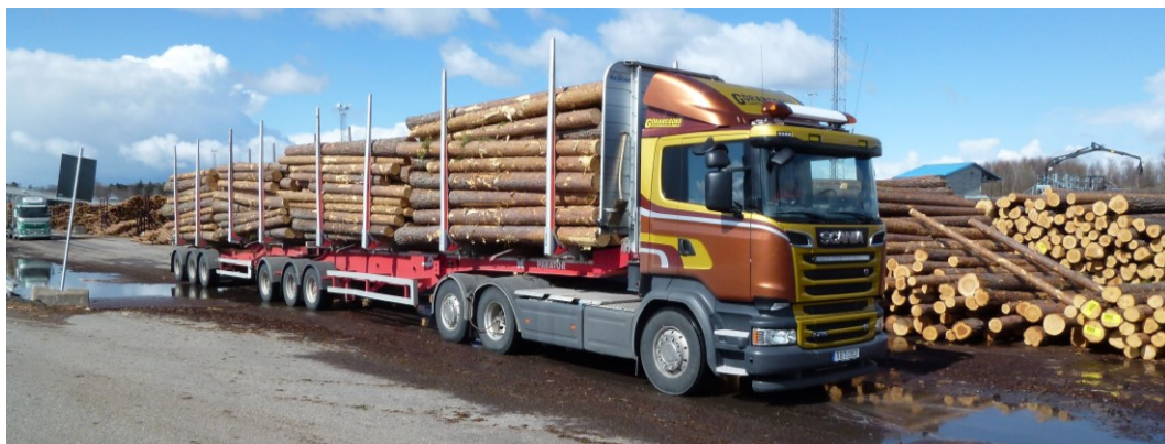
Figur 34 Genom att tänka stort och tänka nytt kan man skapa helt nya fordon. Här ett försök med ett 25,25 meter långt ekipage avsett för fyra travar. Göranssons Åkeri, Färila.
