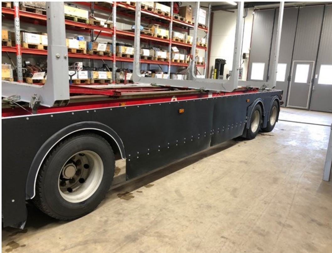
Figur 4. Den aerodynamiska kjolen i närbild.
