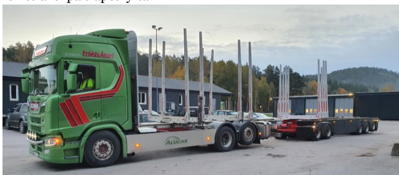
Figur 3. Timmerfordonet som användes vid utrullningsförsöket. Släpet är försett med turbulenshindrare kjolar och bankarna är manuellt sammandragna.
