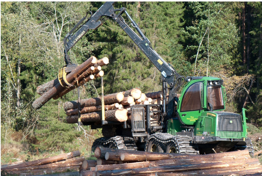
Figur 3. Skotare under pågående lossning vid bilväg.
