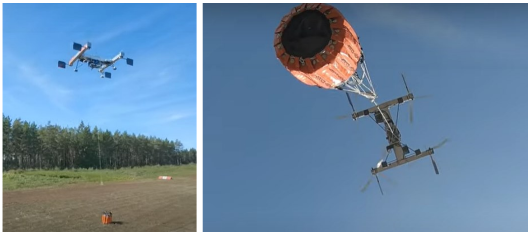
Figur 3. ACC Innovations ThunderWasp-drönare vid lyftning av vatten i en bambi-bucket vid Västerviks flygplats. Källa: Drone Center Sweden
