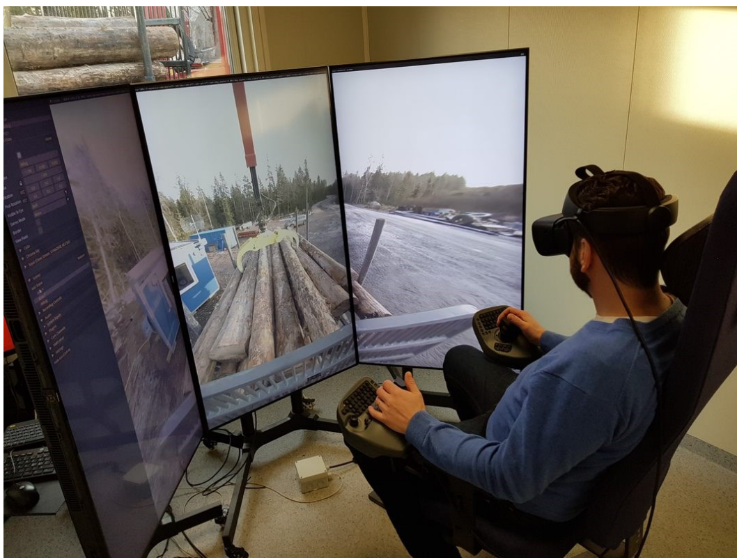
Figur 4. Bildskärmarna i Skogforsks fjärrstyrningslaboratorium och en förare som lastar stockar med VR-glasögon.
