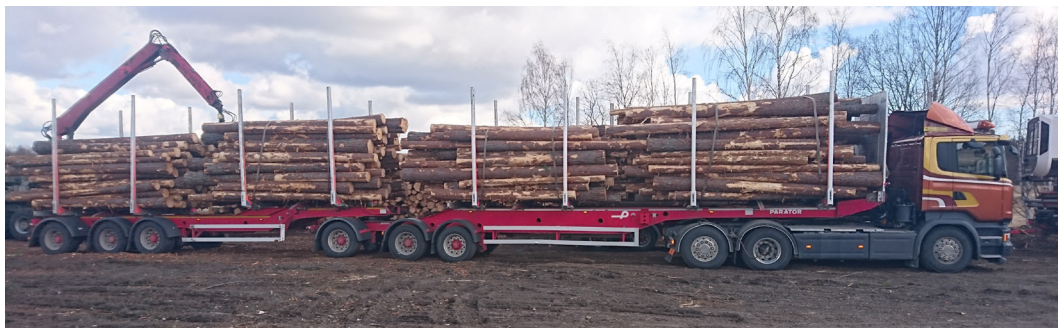
Figur 7. Försök med ett virkesfordon för fyra travar inom 25,25 meter. Foto: Henrik von Hofsten
