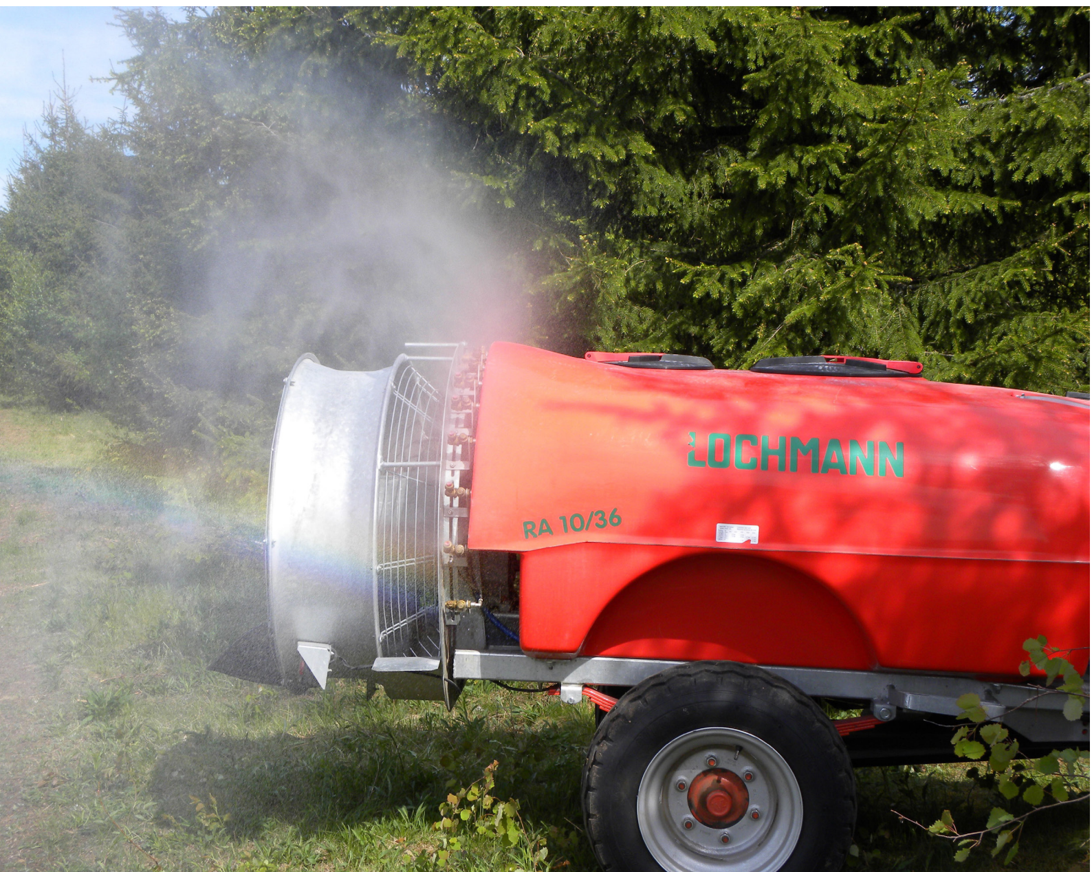
Bildtext: Fläktspruta använd vid storskalig blomningsstimulering i granfröplantager. Foto: Curt Almqvist
