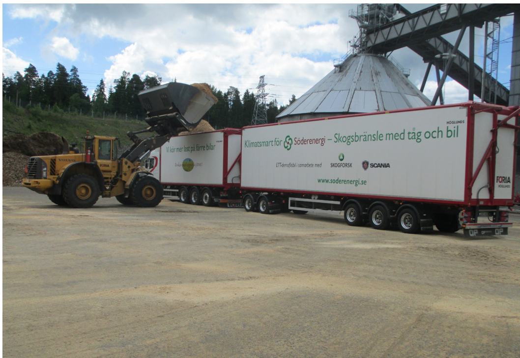
Försöksfordonet i 74-tonsutförande med lastbil, dolly och trailer. Foto: Henrik von Hofsten
