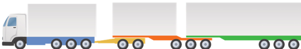
Figur 3. Försöksfordonet i tolvaxligt utförande med en tillåten bruttovikt om 98 ton.
