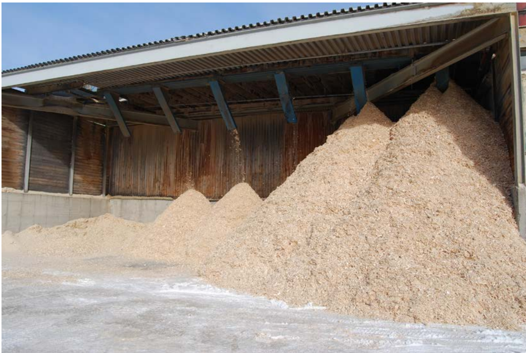
Figur 38. Exempel på flisficka på sågverk. Foto: Anders Lycken, RISE
