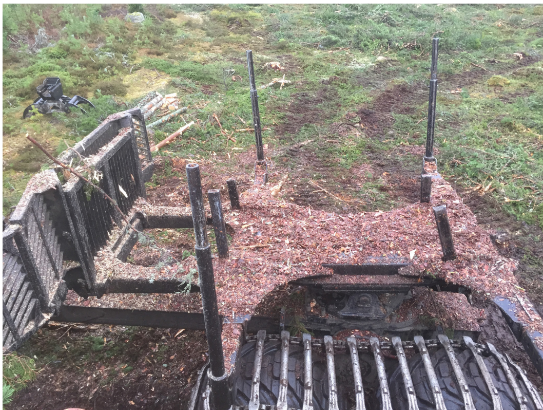
Figur 3. Lastredet på Komatsu X19. Lastredets botten är tät mellan stöttorna i mittenfacket, vilket tillsammans med ett extra par skiljestöttor kan underlätta sortering av kubbsortiment.
