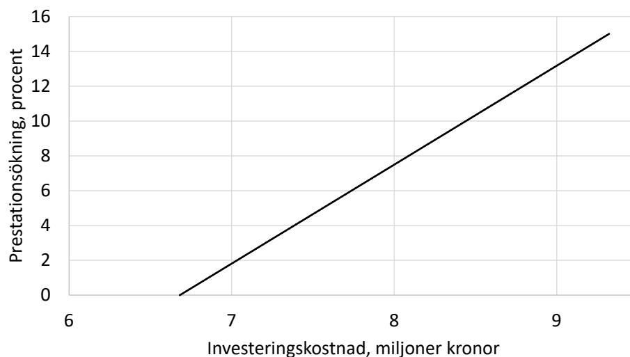
Figur 1. Kostnadsutrymme för tekniska förändringar av drivare. Förändringar som hamnade över linjen bedömdes som lönsamma och inkluderades i analysen. Kalkylräntan var 3 procent.
