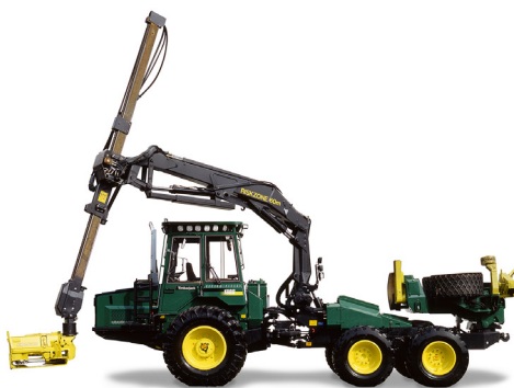
Figur 4. Vänster. Tvågreppsskördaren Timberjack 1880. Notera kranen med lång huvudarm och utskjut/teleskop som fortsätter genom vippan (Bild: Fallaskog 2019). Höger. Rottne F15 med en modern vikarmskran. Notera att utskjutet inte fortsätter genom vippan (Bild: Rottne 2019).
