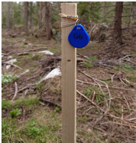
Figur 5. Bild på träkäpp vid en mätpunkt. Den blå brickan är en NFC-tag, kodad med mätpunktens identitet (G6). NFC-taggar användes tillsammans med egenutvecklad programvara för att i mobiltelefon registrera tiden då mätning skedde på de olika mätpunkterna
