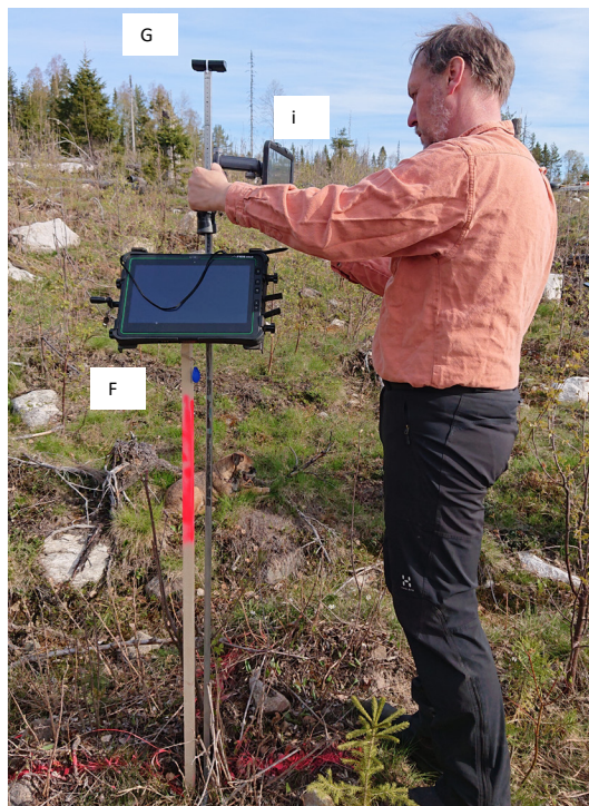
Figur 4. Satellitmottagare monterade på stålställning (nr 2) för att möjliggöra samtidig mätning. G indikerar Garmin GLO, i – iPad och F – FIDS Zelo.
