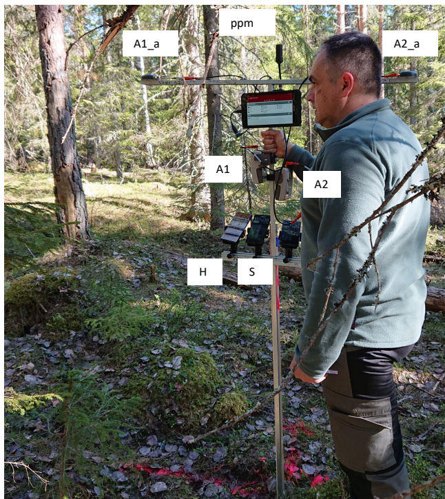
Figur 3. Satellitmottagare monterade på ställning (nr 1) för att möjliggöra samtidig mätning. A1_a och A2_a indikerar antennerna tillhörande Arrow-enhet 1 och 2, A1 och A2 Arrow-enhet 1 och 2, ppm – ppm 10xx, H – Huawei mobiltelefon, S – Sony mobiltelefon. På bilden syns inte mottagaren Garmin 62.
