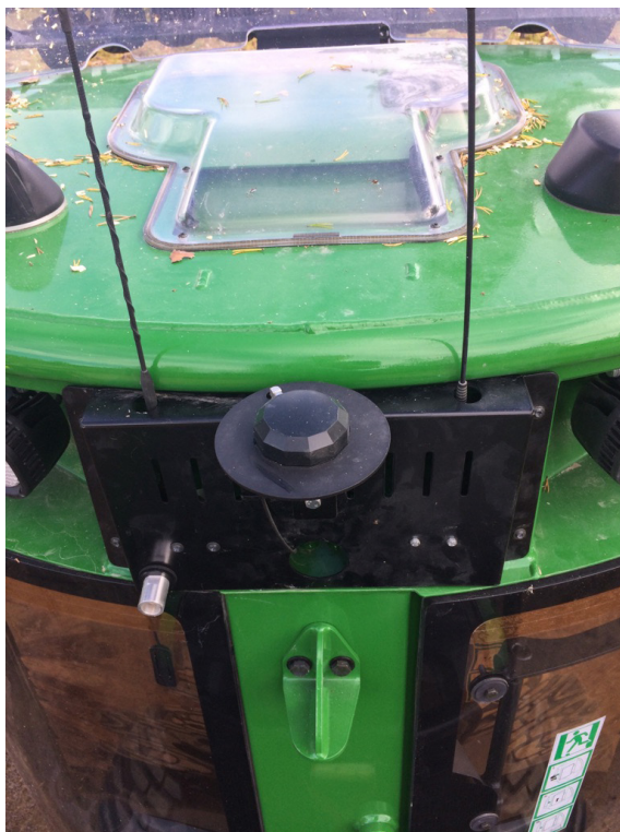
Figur 9. Placering av GNSS-mottagarens externa antenn.
