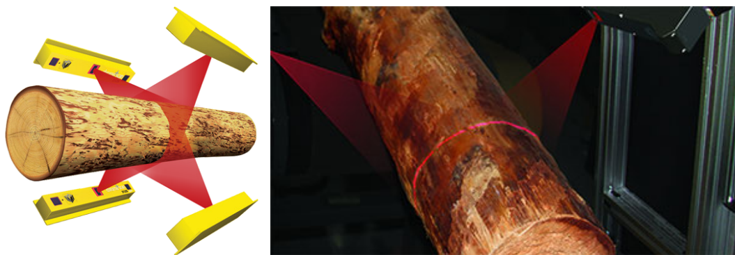
Figur 8. Vänster: Illustration av lasermätram (3D). Källa: LMI Technologies (2019). Höger: Foto av belysning från lasermätram. Källa: LMI Technologies (2016).
