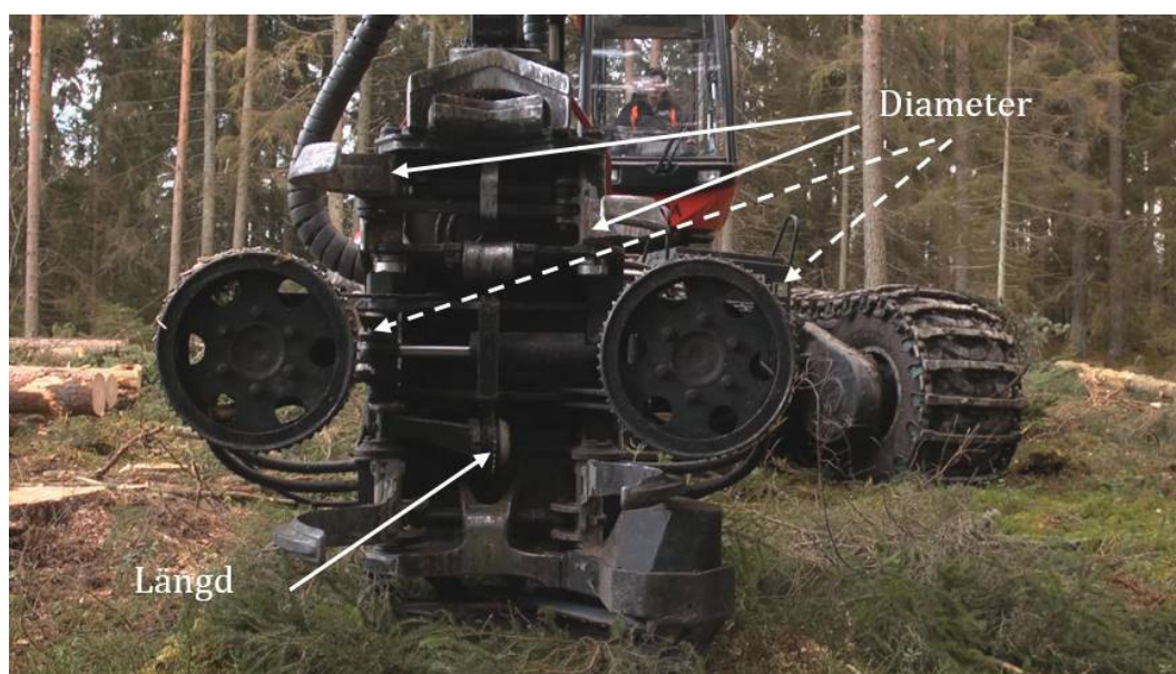
Figur 3. Delar av skördaraggregatet som används för mätning av längd och diameter. Längden mäts med ett mät hjul medan diametergivarna sitter monterade antingen i de övre kvistknivarna eller i matarhjulen. Källa: Nordström & Hemmingsson (2015).
