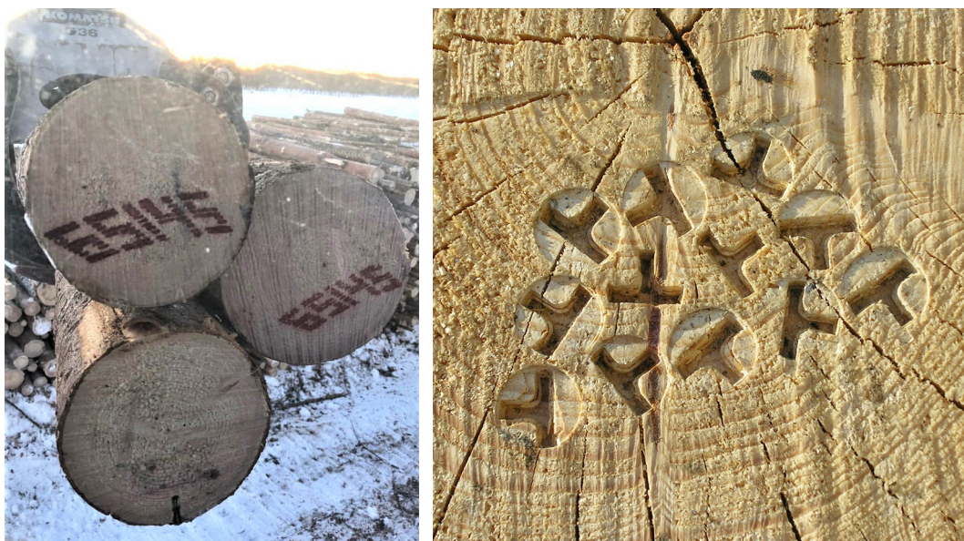
Figur 4. Vänster: Logscom-stämpling av ändytor motsvarande dagens manuella skyddsmärkning. Källa: Logscom (2019b). Höger: Närbild på Otmekta-stämpling av ändyta. Källa: Otmekta (2019).
