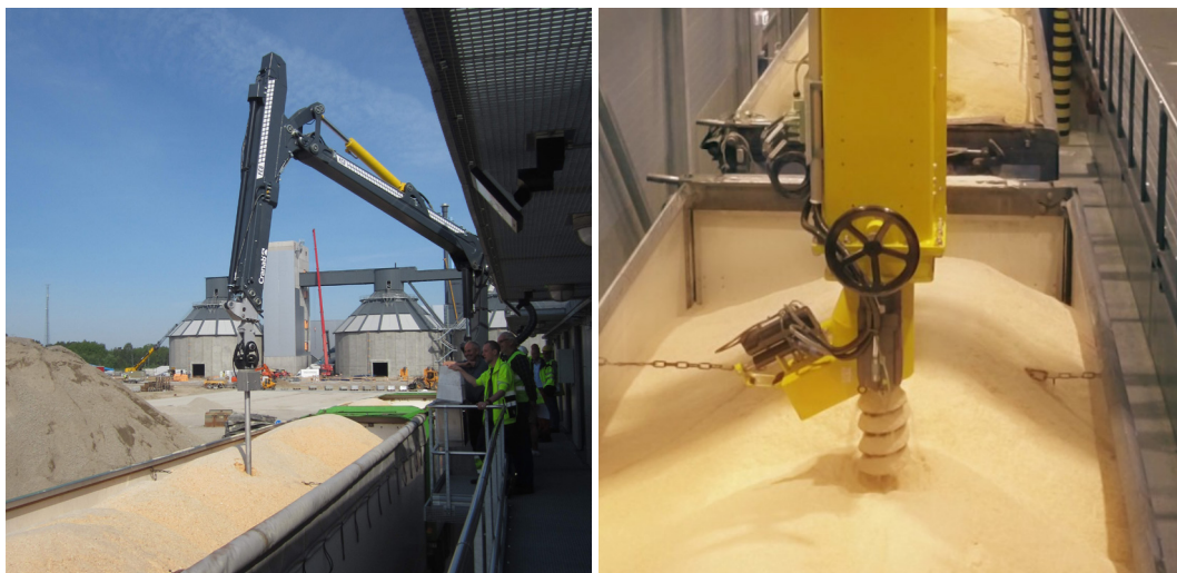
Figur 15. Vänster: NIR-sond. Källa: Bestwood (2019). Höger: Provtagningsborr. Källa: Prometec (2016).
