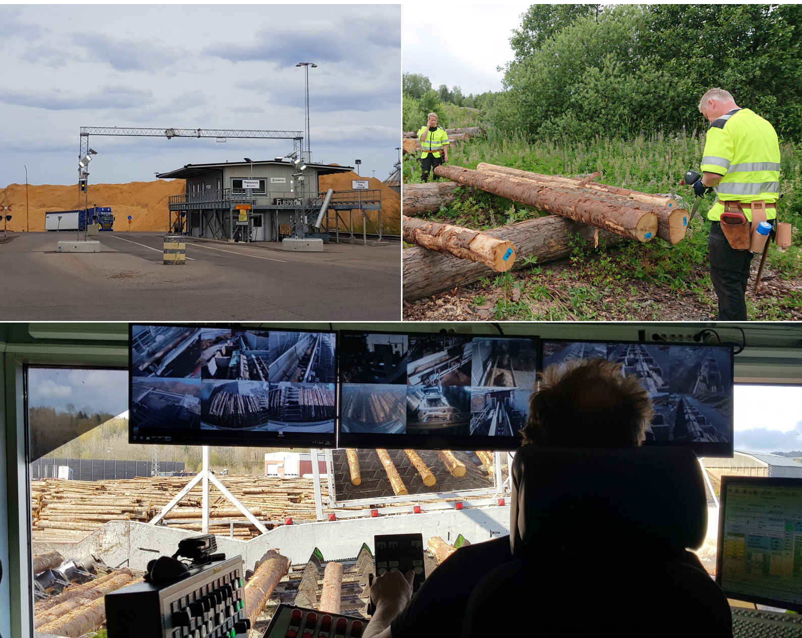
Vänster bild: Mätplats med travmättningsrigg. Höger bild: Kontrollmätning av stockar med klave. Undre bild: Klassning och bedömning av stockar innan mätram vid sågverksintag. Foton: Maria Nordström & Kari Hyll
