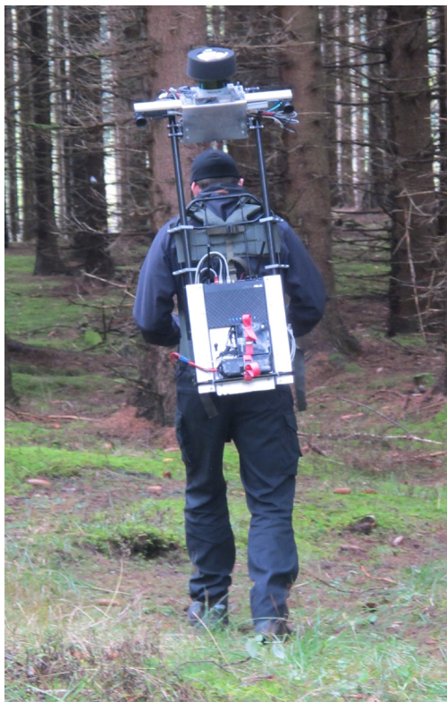
Figur 9. Mätssystemet monterat på bärram med laserskanner i toppen. Foto: Skogforsk
