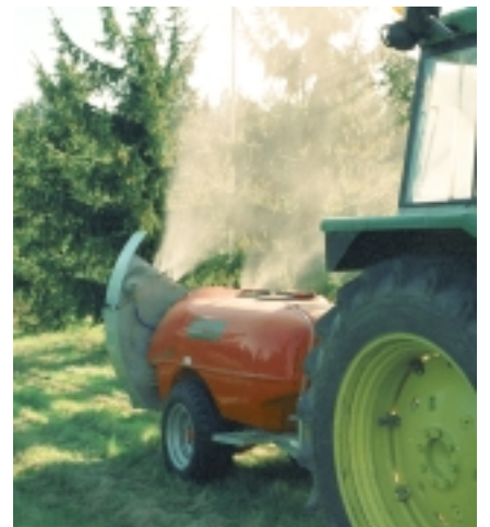
Figur 4. Fläktspruta med höghöjdstillsats vid besprutning av sex m höga granar med det biologiska bekämpningsmedlet Bacillus thuringiensis var. kurstaki/aizawai .
