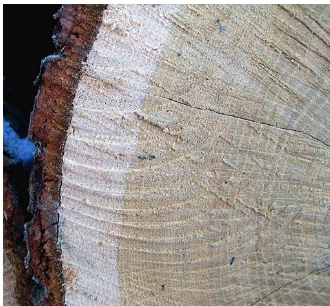
Figur 1. Bandporigt lövträd (ek) med tydliga årsringar (t.v.) och ströporigt lövträd (vårtbjörk) med ofta otydliga årsringar (t.h.).
