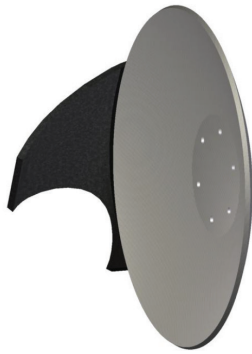
Figur 9. Skillnaden i tallriksvinkeln mellan sidan med vingen och den utan.
