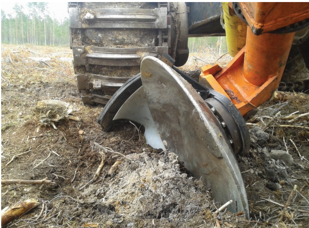
Bild 2. Vingen med polyetenkappa syns bakom tallriken och framför boogien.
