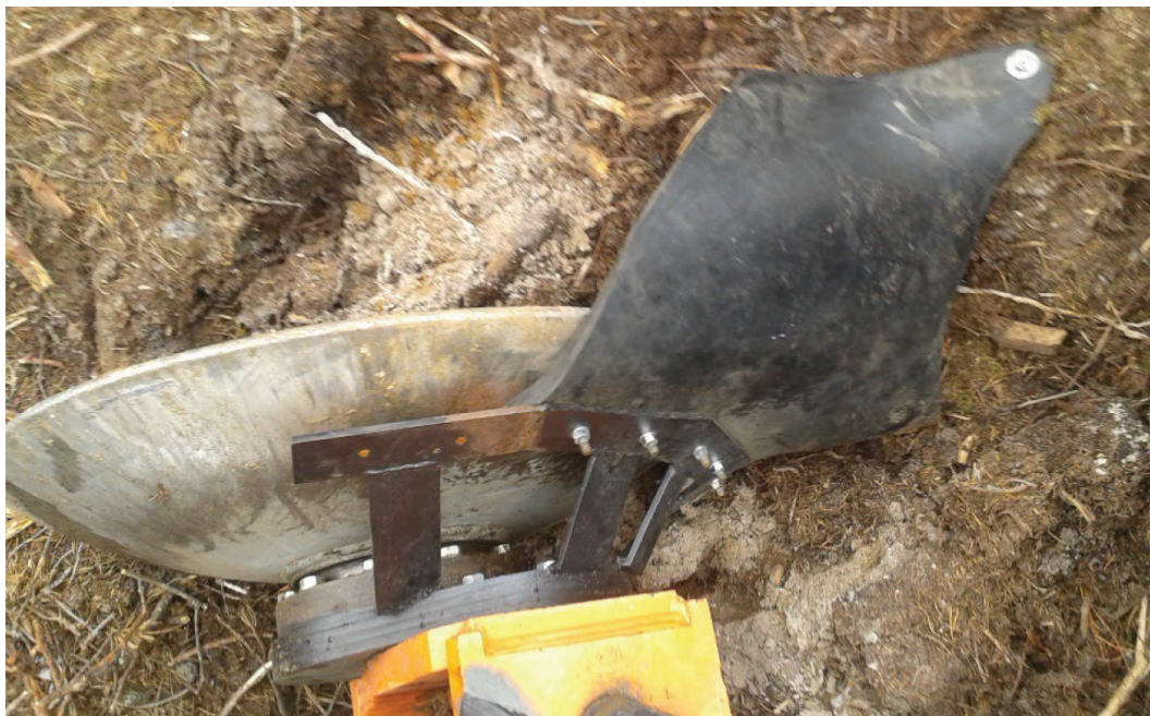
Bild 1. Vy av vingen uppifrån med plåten för att förskjuta tallriken framåt. Foto: Anders Högdal
