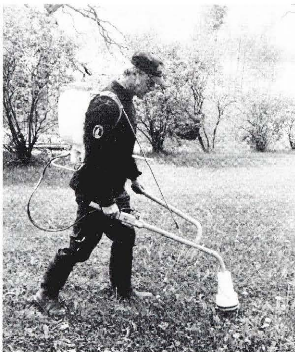
Bild 1. Besprutningsutrustning mot snytbaggeangrepp, som används i samband med plantering.
