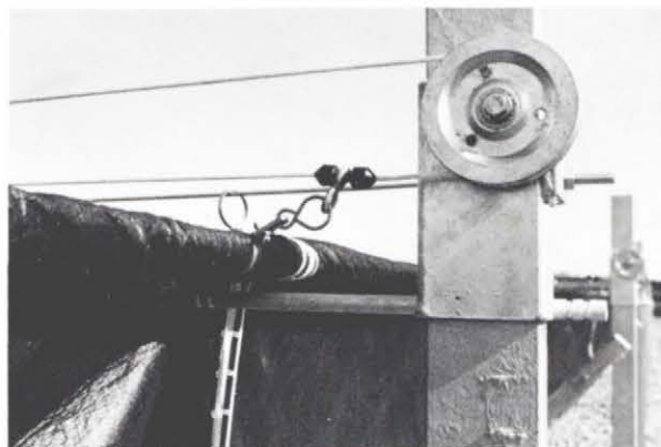
Bild 6. Draglinorna går över brythjul som lagrats i stolparna.
