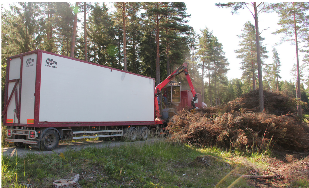
Huggbil under arbete med flisning av en grotvälta placerad nära vägen vilket är fördelaktigt för att nå allt material med kranen. Foto: Henrik von Hofsten, Skogforsk.
