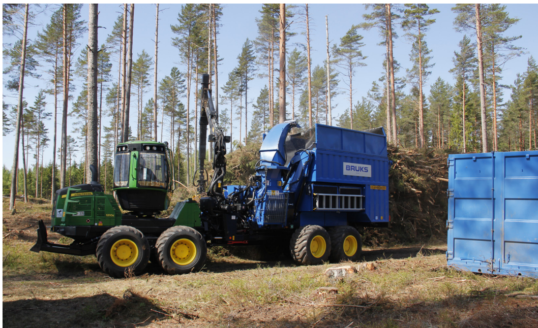
Skotarmonterad sönderdelare. På bilden står containern alldeles intill vilket är ovanligt, om än önskvärt. Foto: Lars Eliasson, Skogforsk.
