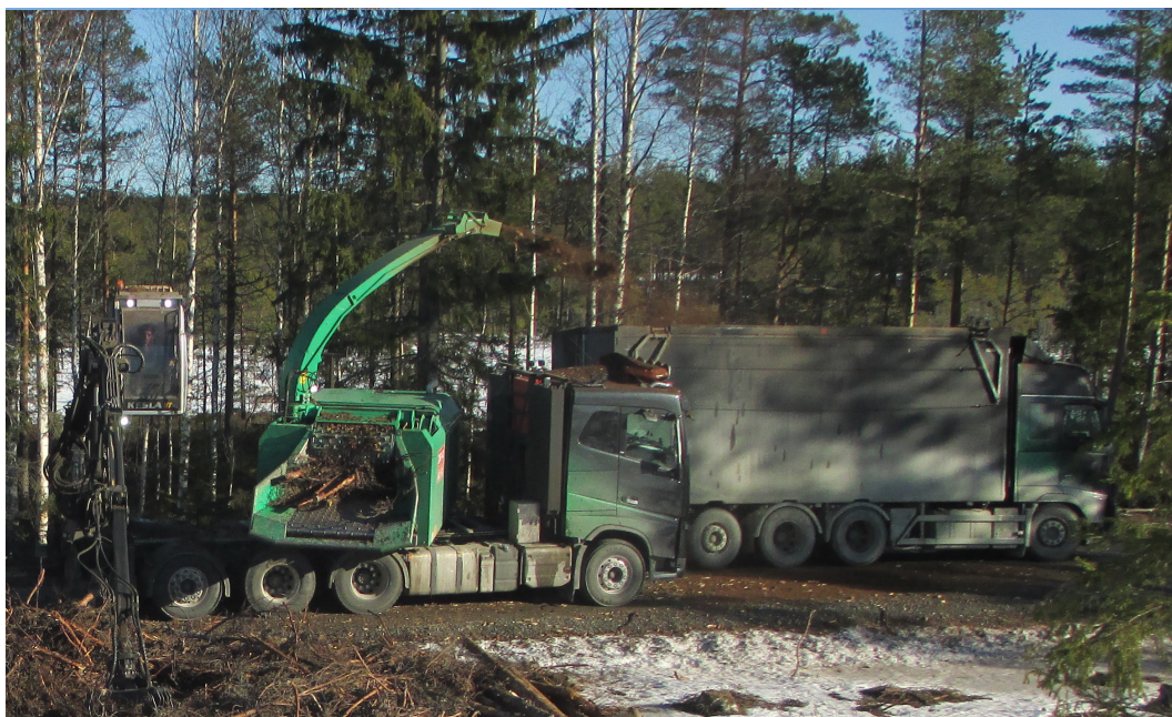
Separat flishugg monterad på lastbilschassie. På bilden har man fått backa in en flisbil utan vagn framför huggen. Flisbilen får sedan hämta vagnen och backa till den innan fyllning. Foto: Henrik von Hofsten, Skogforsk.
