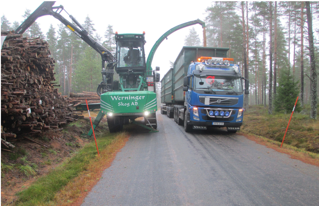
Exempel på en specialbyggd, självgående flismaskin med viss terrängpotential. I detta fall har den kört ner i diket för att lämna plats åt containerbilen på vägen. Foto: Henrik von Hofsten, Skogforsk.
