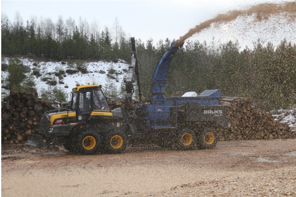
Figur 1. Den studerade maskinen, en Bruks 1006 monterad på en Ponsseskotare.
