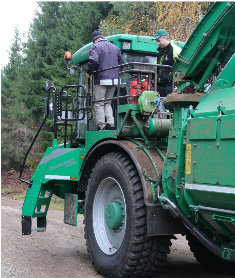
Figur 8. Utfällbar stege och kraftiga räcken minskar risken för fallolyckor.
