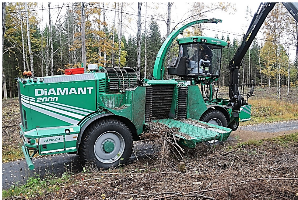
Figur 2. Den studerade maskinen, Albach Diamant 2000 med hissad hytt och de två lyftbara axlarna upplyfta.
