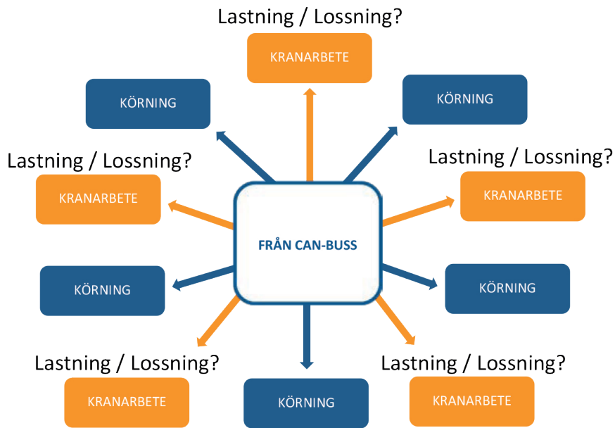
Figur 2. CAN-bussignaler i sig gör det inte möjligt att hålla isär lastnings- och lossningsarbete. Det går heller inte att identifiera ett enskilt lass.
