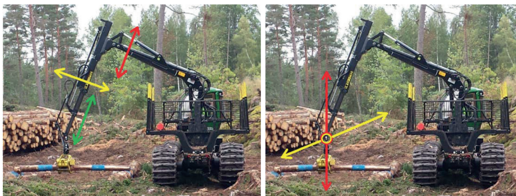
Figur 1. Den vänstra bilden visar de möjliga rörelseriktningarna för de olika krandelarna. Vid konventionell styrning av kranen kombinerar föraren de tre delarnas rörelse för att uppnå önskad kranrörelse. Den högra bilden visar de ungefärliga rörelseriktningarna vid kranpetsstyrning som föraren kombinerar för att uppnå önskad kranrörelse.
