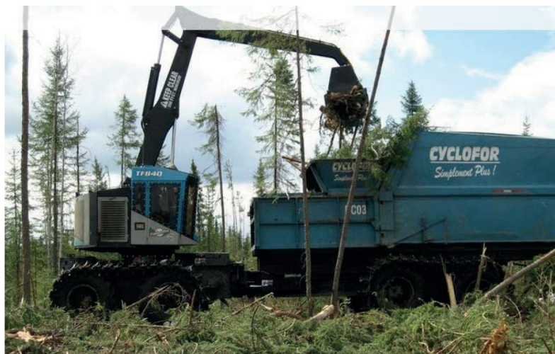
Bild 6. Komprimering av osönderdelad grot på hygge. Foto: Cyclofor.
