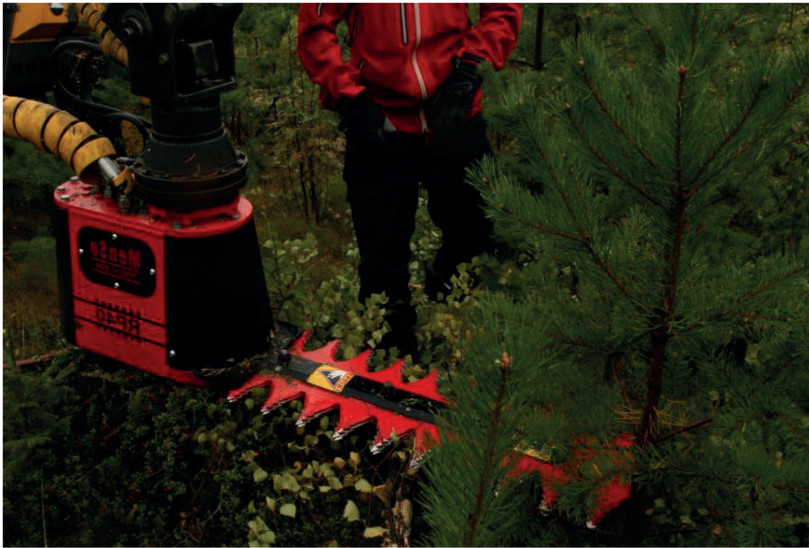
Figur 3. MenSe RP40 -röjaggregat från MenSe Oy, Finland. Foto: http://www.puuntuottaja.com/
