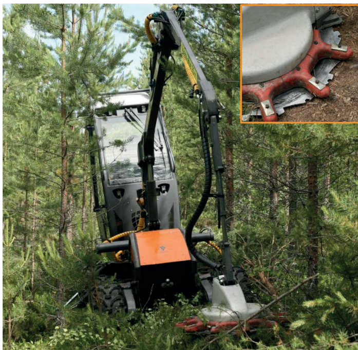
Figur 2. Finländska Usewood Oy:s UW40-slyröjare (röjaggregat) utrustas antingen med såg eller bett. W40 monteras på en beståndsgående basmaskin och den marknadsförs både i Finland och i Sverige som ett paket med Usewood PRO -miniskördare (på foto) vars vikt är 1,8–2,3 ton och effekt 18–33 kW (Usewood Oy 2017; Terrängservice AB 2017).
