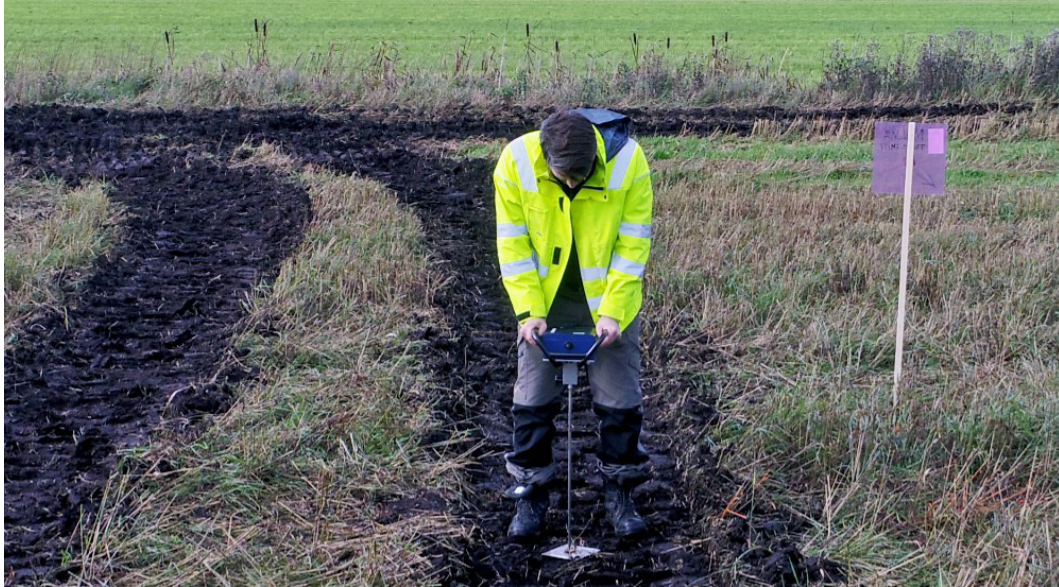
Figur 9. Konpenetrometer användes för att undersöka markens beskaffenhet före, under och efter spår-djupstest.
