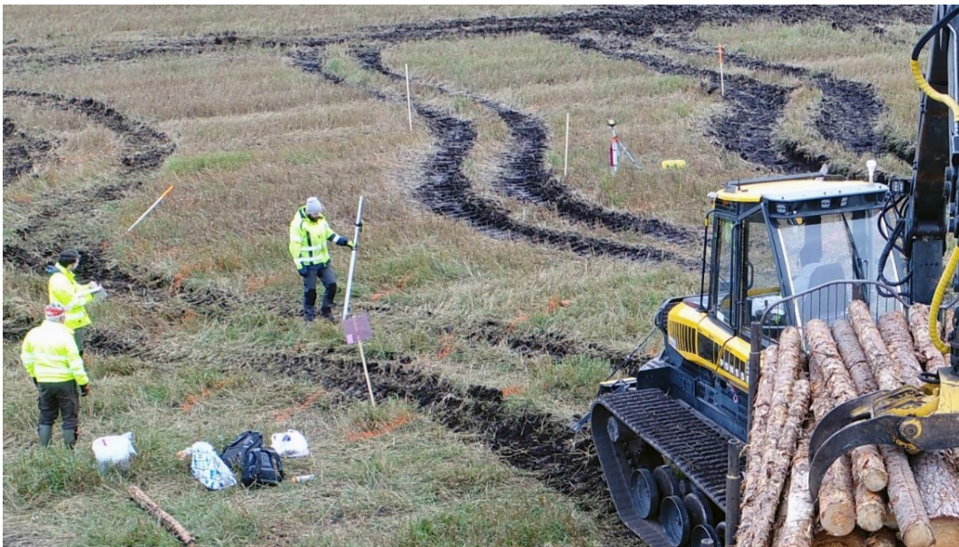
Figur 8. Spårdjupsmätning med rotationslaser och mätsticka på slalombanorna. (Den maskin som syns på bilden är en prototyp med gummiband, från ett annat test än det som beskrivs i denna Arbetsrapport).
