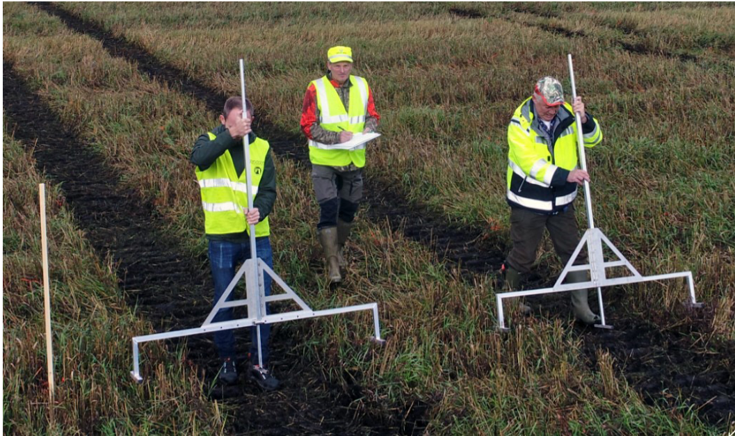
Figur 7. Spårdjupet mäts på de raka banorna.
