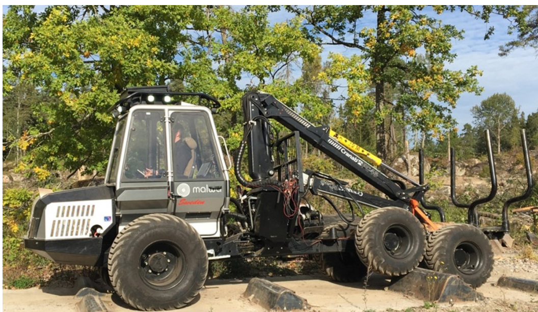
Figur 2. Malwas skotare 560C på Skogforsks bana för vibrationstest i Jälla. Foto Anneli Olsson.
