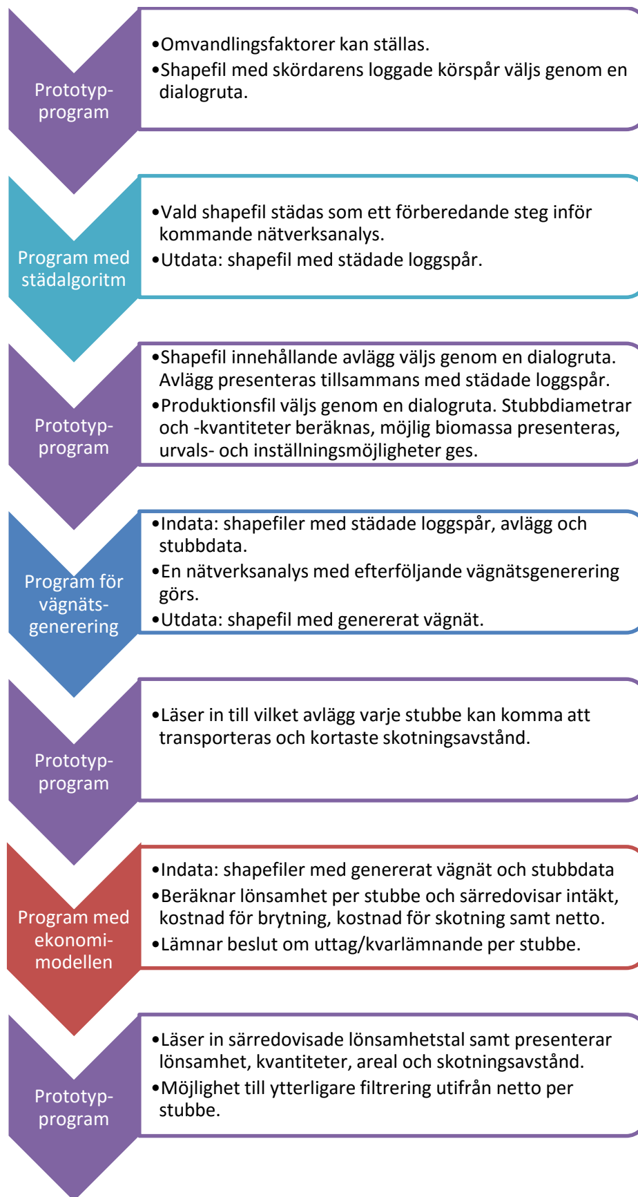
Figur 2. Programflöde med in- och utdata mellan programmoduler och prototypprogram.
