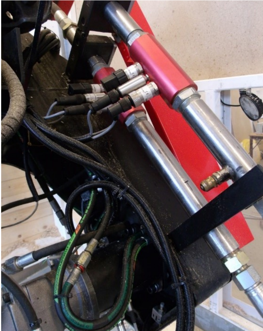
Figur 10. Givare monterade för mätning av hydrauloljans tryck, flöde och temperatur före respektive efter sågmotorn.
