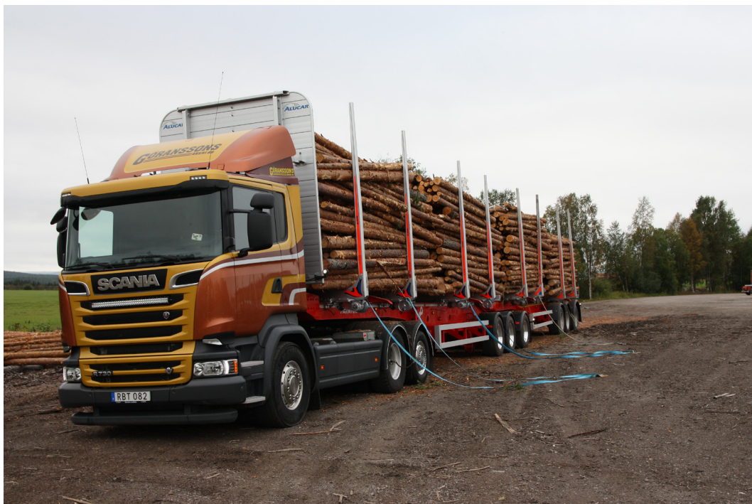
Figur 17. Push-fordonet den 9 september 2016. Provlastning av fyra travar till bruttovikt 74 ton. Foto: Rolf Björheden, Skogforsk
