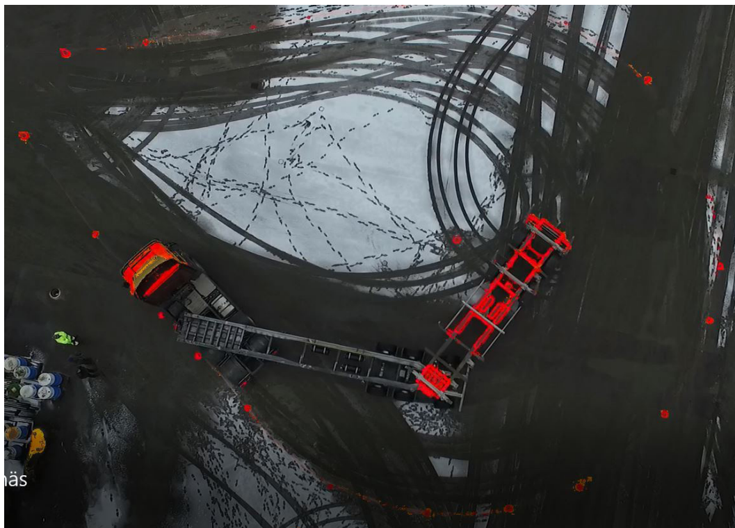
Figur 16. Försöksfordonet under svängradietest, för att säkerställa systemets framkomlighet på skogsbilväg. Foto: Erik Viklund, Skogforsk
