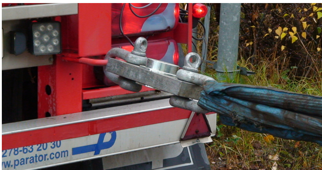
Figur 7. Dragkraftsgivaren monterad mellan push-fordonet och en hjullastare. Foto: Henrik von Hofsten, Skogforsk
