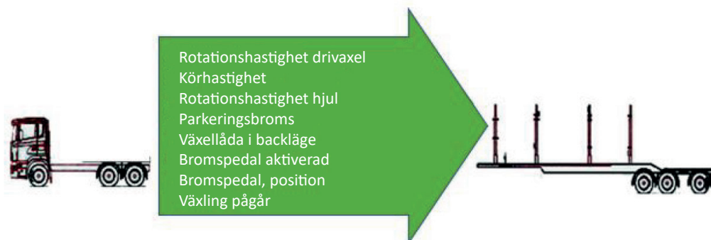
Figur 2. Exempel på CAN-bussignaler som utnyttjas för påbyggnad.
