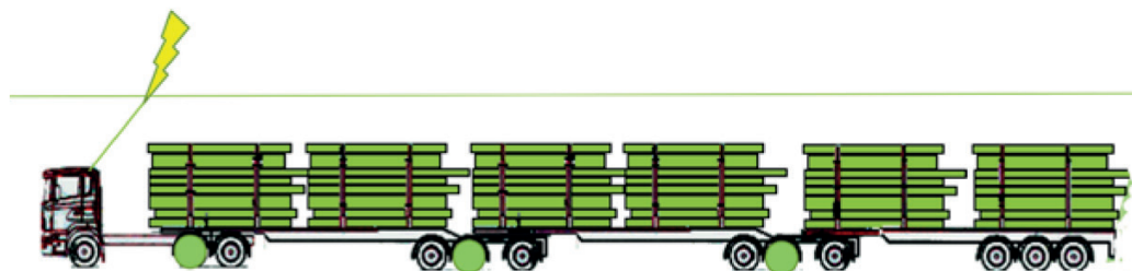
Figur 18. Exempel på dragbil med flera efterfordon med separata elektriska framdrivningssystem. De drivande hjulen är grönmarkerade.
