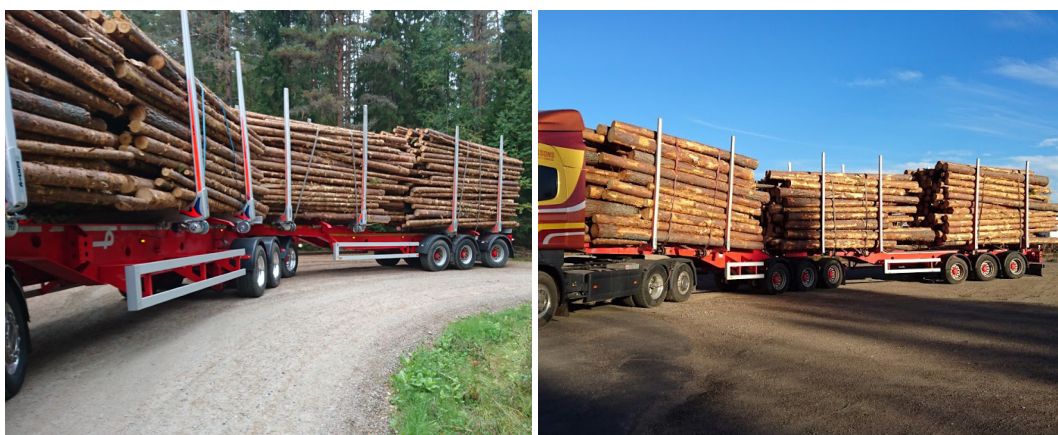
Figur 18. Lägre lasthöjd och mindre mellanrum mellan lastdelarna ger lägre luftmotstånd. Foton: Rolf Björheden, Skogforsk
