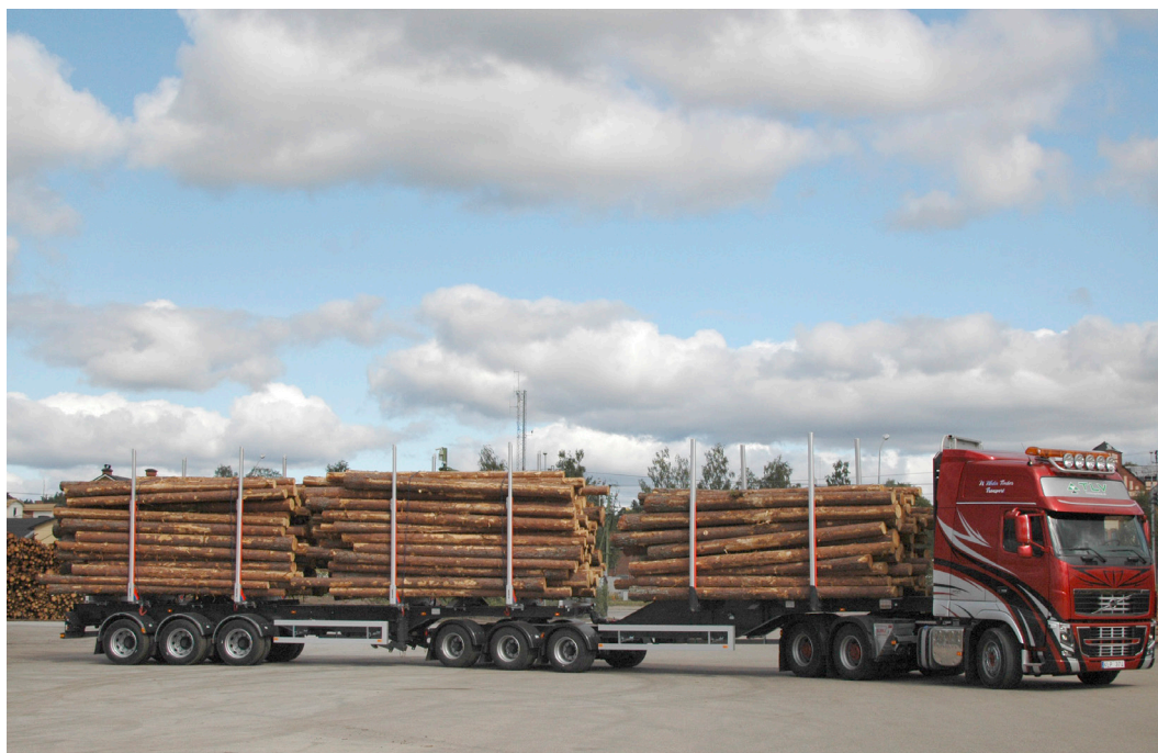
Exempel på gruppbil. Denna biltyp har ingen egen kran utan lastas av separatlastare. Fordonet på bilden är byggt enligt konceptet dragbil-link-trailer till skillnad mot grupp bilen på framsidan som är byggd med lastbil och vagn.
