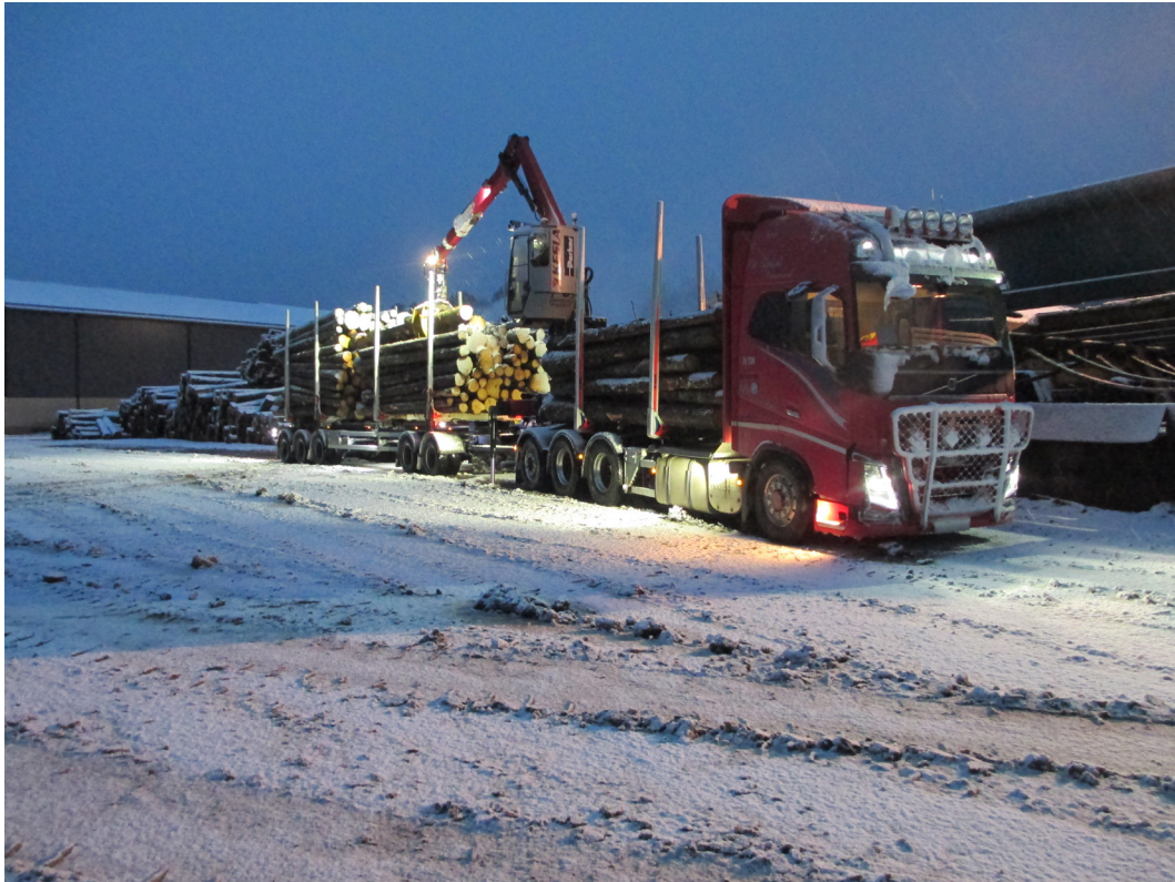
Ett exempel på rundvirkesbil som lastar och lastar av med egen kran. Denna bil är stationerad i Dalsland.
