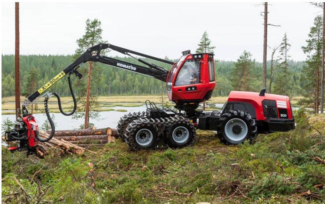
Figur 2. Komatsu 931, på bilden med ett C144 aggregat – i studien utrustad med 365. Foto: Komatsu.
