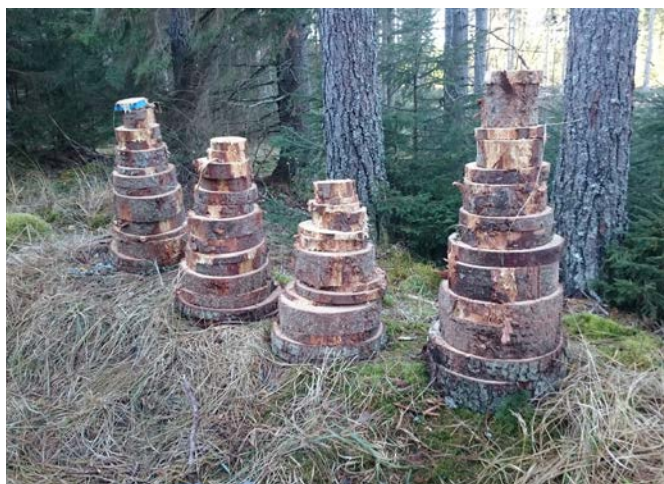
Figur 18. Trissor från de sju stockarna kapade av de fyra maskinsystemen. Foto: Björn Hannrup, Skogforsk.
