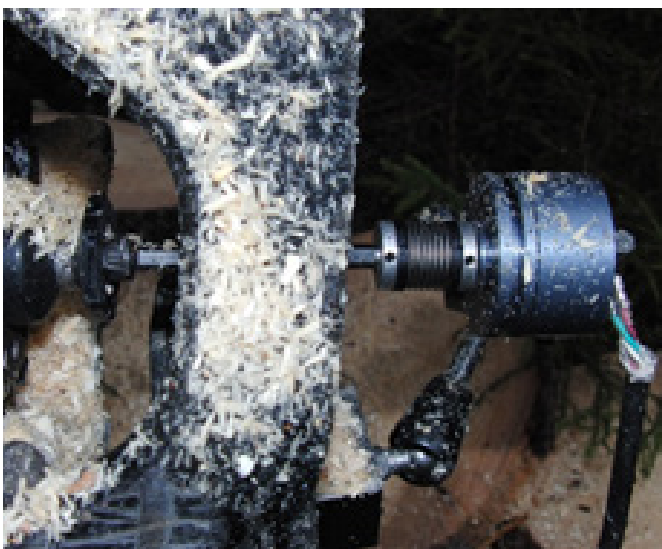
Figur 14. Pulsgivare ansluten till kedjehjulets nav för mätning av sågmotorns varvtal. Foto: Petrus Jönsson, Skogforsk.
