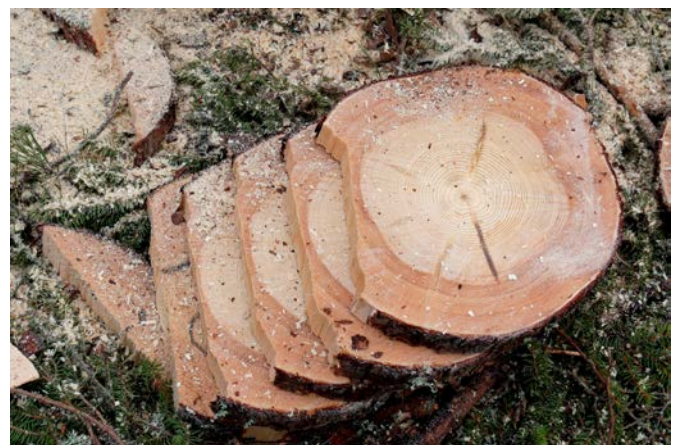
Figur 24. Illustration av trissmetoden. Trissorna är kapade ur samma stockände och genom att summerna trissornas tjocklek kan kapsprickans längd uppskattas. Foto: Björn Hannrup, Skogforsk.
