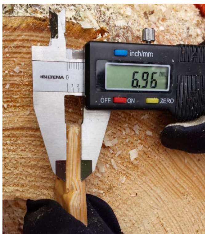
Figur 25. Illustration av mätningarna av inträngningsdjup för dubbskador. Foto: Maria Nordström, Skogforsk.
