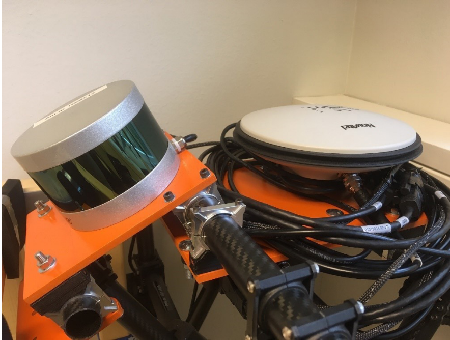
Figur 5. Det mobila mätsystemet som användes i studien. Foto: Johan Holmgren, SLU
