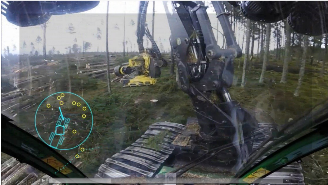
Figur 11. Beslutsstöd i skördarens head-up display med trädpositioner till vänster som kan peka på vilka stammar som ska avverkas. Foto: Staffan Till & Anders Nordlie.
