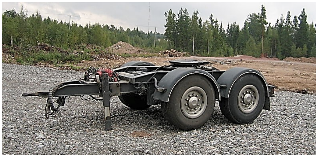
Figur 7. Dolly med vändskiva för koppling av påhängsvagn. Vändskivan är den plana ytan överst på dollyn. Se även Figur 8.
