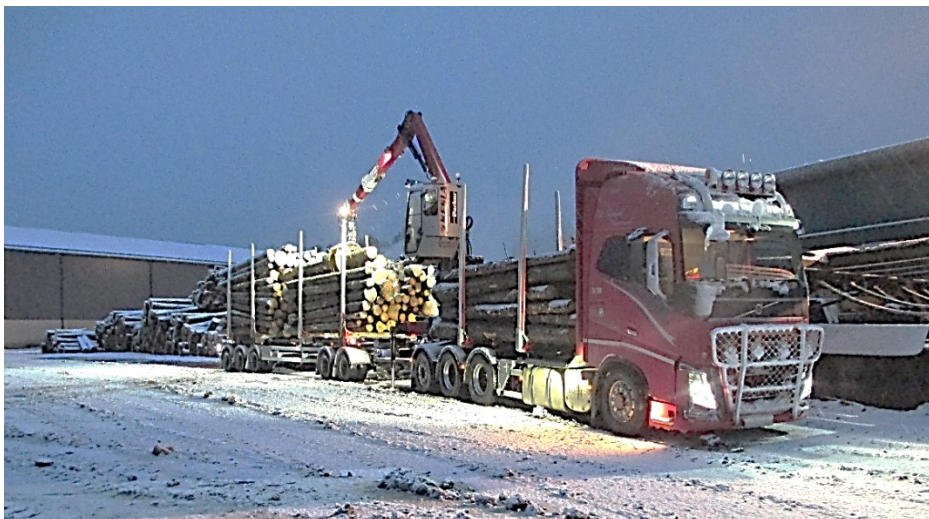
Figur 6. Eds Träfrakt lastar av sitt ST-ekipage vid sågen. Fast och centrummonterad Z-kran och femaxlig vagn.
