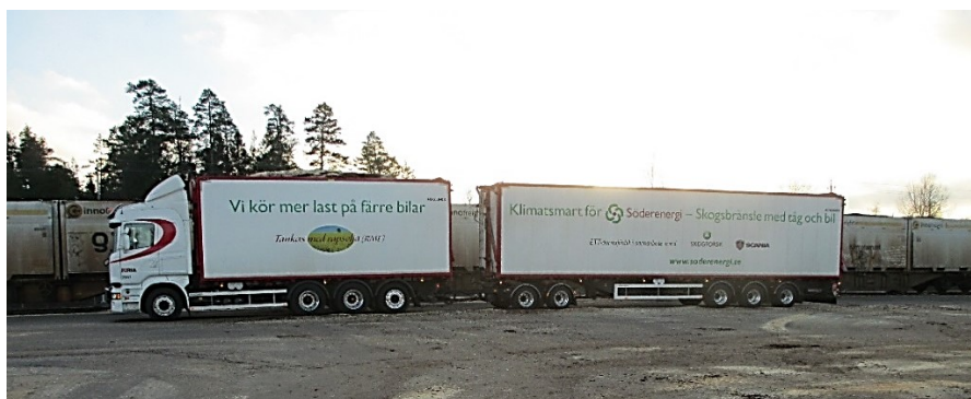
Figur 5. Ove Lindkvists 74 tons flis-ekipage kör flis från järnvägsterminalen i Nykvarn till Söderenergis värmeverk i Södertälje. Scania R730 med dolly och påhängsvagn från Parator samt påbyggnad från OP Höglunds.
