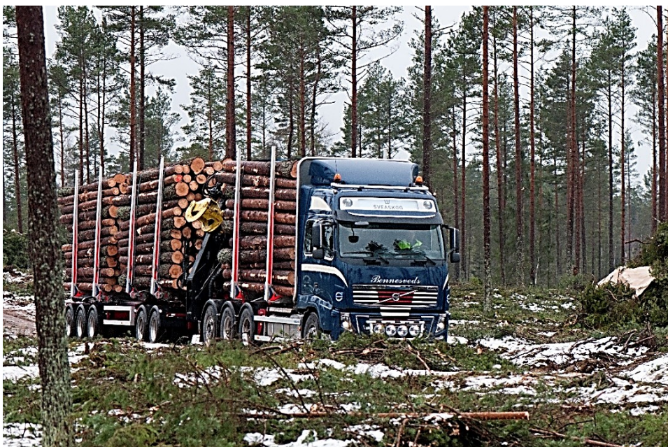
Figur 3. Thorbjörn Bennesveds ST-bil (74 tons maxbruttovikt) med asymmetriskt placerad Z-kran och CTI på alla axlar.
