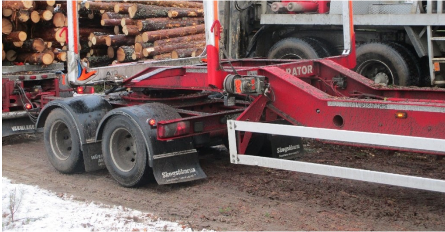
Figur 13. Exempel på svanhals. Till höger, utanför bild finns påhängsvagnens trippel. Boggin på bilden är dollyn och svanhalsen är den uppbyggda delen över dollyn.
