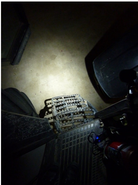
Figur 16. Fotografiet visar hur LED-belysningen lyser upp traktorstegen sett inifrån hytten.
