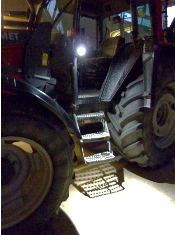
Figur 15. Fotografiet visar placering och resultat med LED-armaturen vid traktorstegen.
