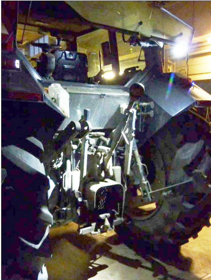
Figur 18. Fotografiet visar placeringen och belysningen av hitch-kroken från LED-armaturen.
