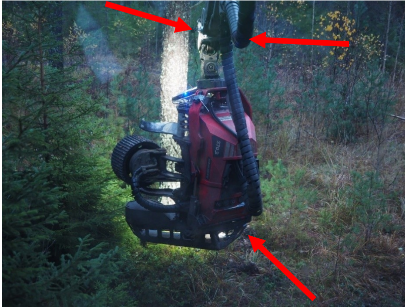
Figur 2. Endast armaturerna ute vid aggregatet är tända. Pilarna markerar placeringen av armaturerna.
