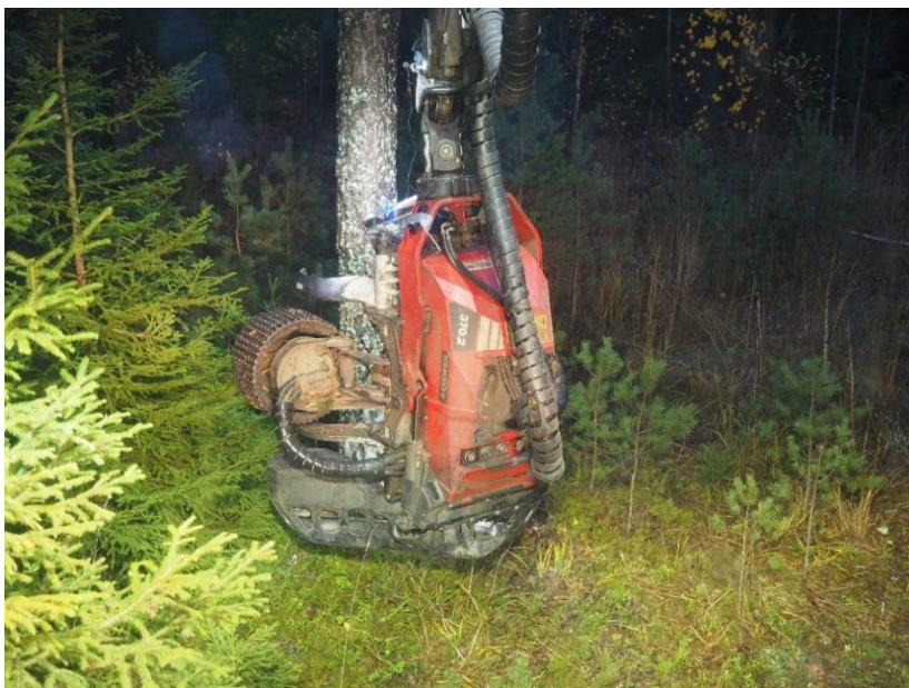
Figur 4. Maskinens ordinarie belysning och armaturerna vid aggregatet är tänd.
