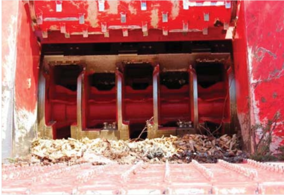
Figur 3. Biberhuggens inmatningsöppning, bakom matarvalsen syns den öppna trumman. Två av de fyra bankar där knivarna sitter monterade skymtar i över respektive underkant på inmatningsöppningen.
