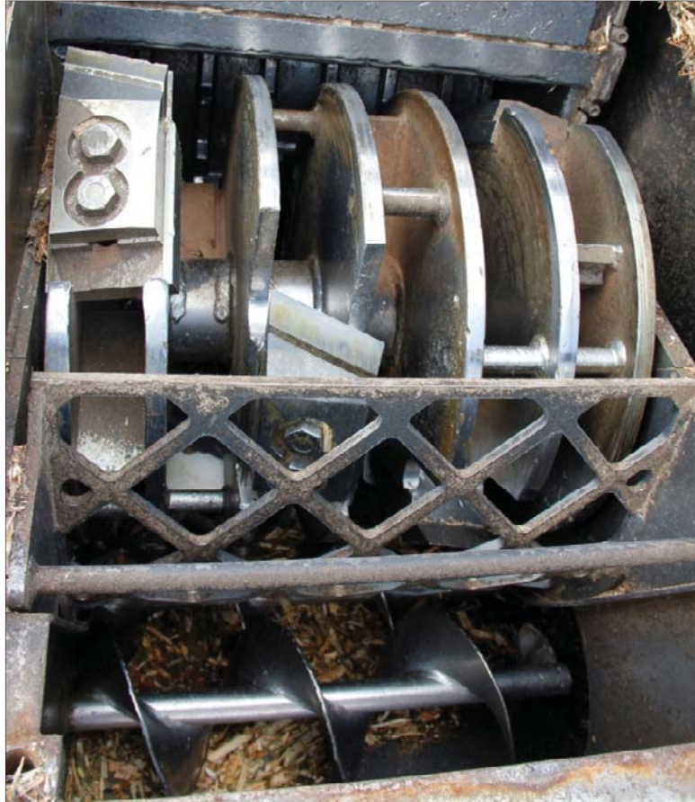
Figur 2. Keslahuggens öppna trumma med de snedslipade knivarna och det kvadratiska sållet.
