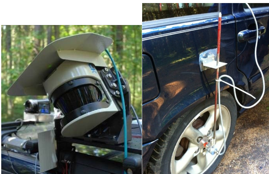
Figur 1. Mätsystemets komponenter monterat på personbil. Laserskanner SICK LMS-511 till vänster och till höger odometer monterad i hjulnavet.
