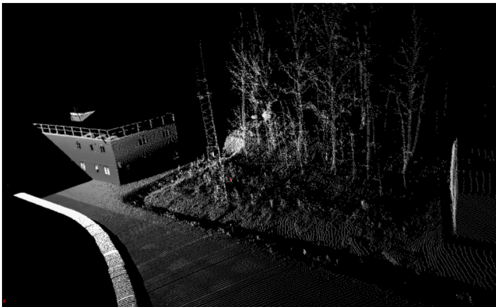
Figur 15. Punktmoln från en bebyggd miljö, baserat på laseravståndsmätningar i kombination med positionsdata från SLAM-systemet. I figuren kan noteras att systemet kan leverera mycket detaljrika punktmoln. Det vita spåret i figurens nedre vänstra hörn motsvarar mätfordonets färdväg.
