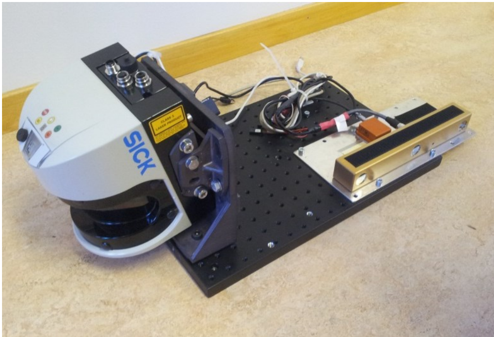
Figur 9. Mätutrustningen monterad på ett optiskt bord som i sin tur monterades på takracket på en Landrover. Till vänster laserskanner SICK LMS-511, till höger positioneringssystemet bestående av stereokamera (guldfärgad) och IMU (orange).
