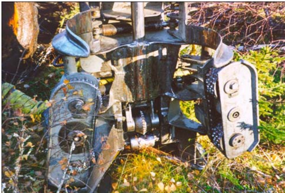
Ponsseaggregat med dubbla valsar på varje sida. Under sommarhalvåret byts dessa ut mot bandmatning.
