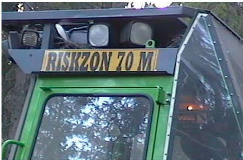
Figur 11. Varningsskyltar flyttade till överkant på hytten.
