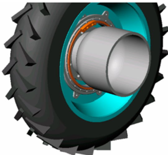
Figur 6. Ringsvivel för montering av CTI på befintliga fordon.
