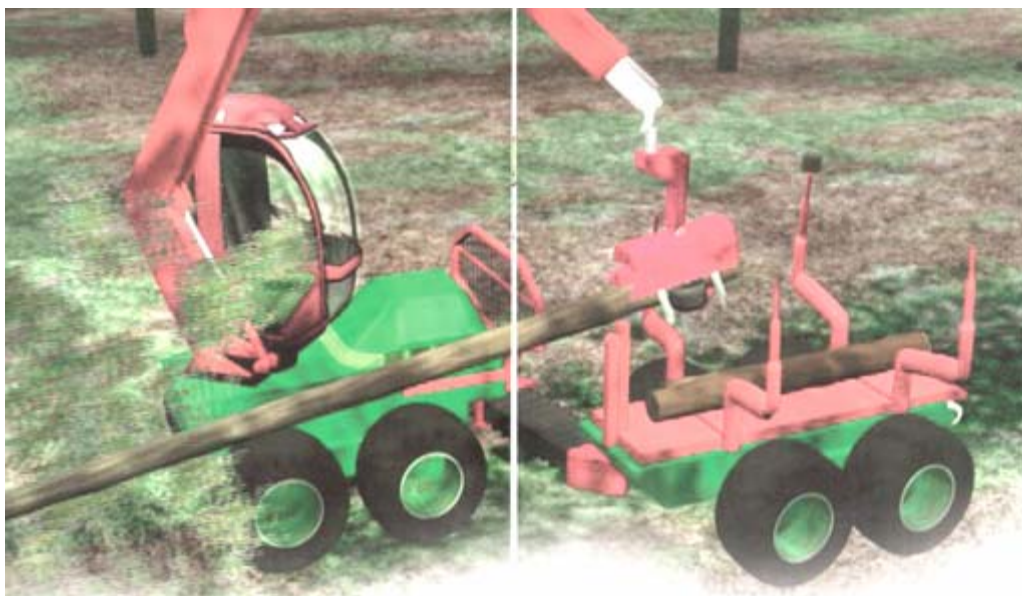
Figur 5. Drivare med dubbla midjor. Källa: Vision 2000, Sydved.
