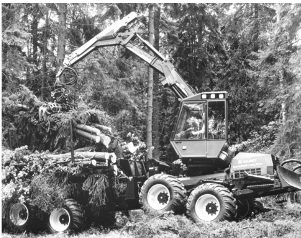
Figur 3. Valmet, runtomsvägande träddelsskördare. Foto: SkogForsk.
