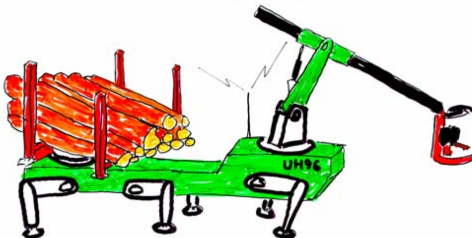
Figur 9. Gående förarlös gallringskörare. Illustration: Ulf Hallonborg.
