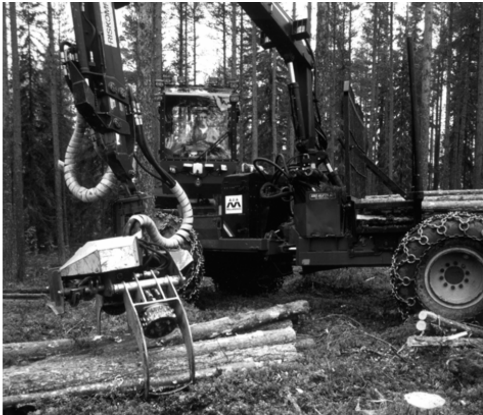
Figur 1. Pogen, en drivare för gallring och medelgrov slutavverkning. Foto: Tillverkaren.
